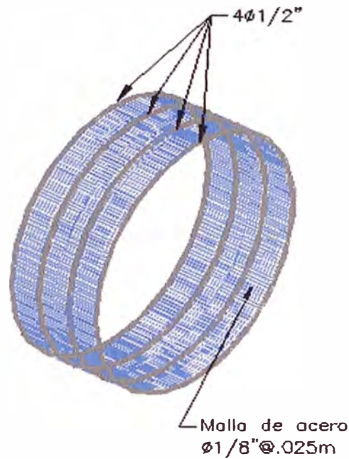
Figura 31.- Detalle de malla de sostenimiento (Fuente: Propia de la tesis, NOV 2011)
