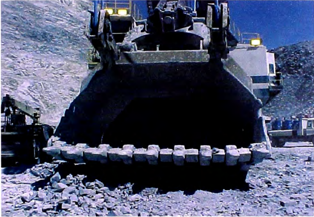
DESGASTE EN ADAPTADORES ENTREDIENTES ASI MISMO EN COMPUERTA Y PAREDES LATERALES
