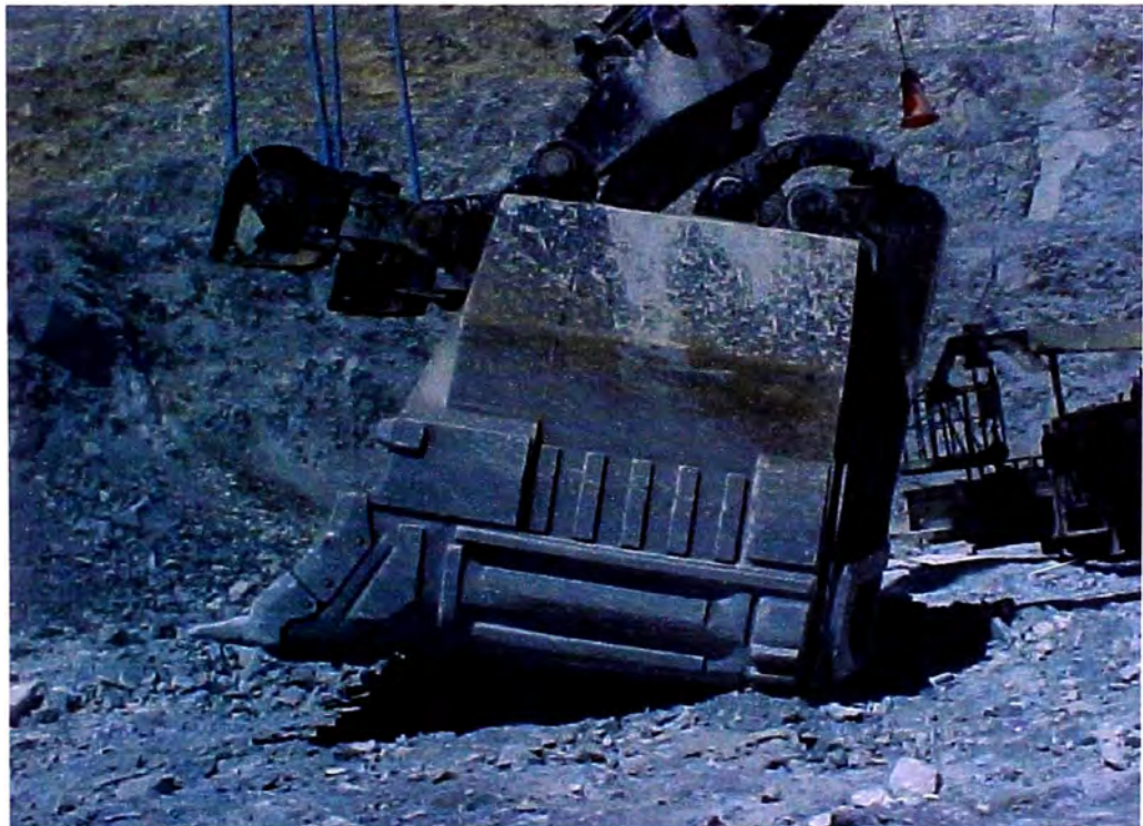
DESGASTE EN LA BASE DEL CUCHARON
