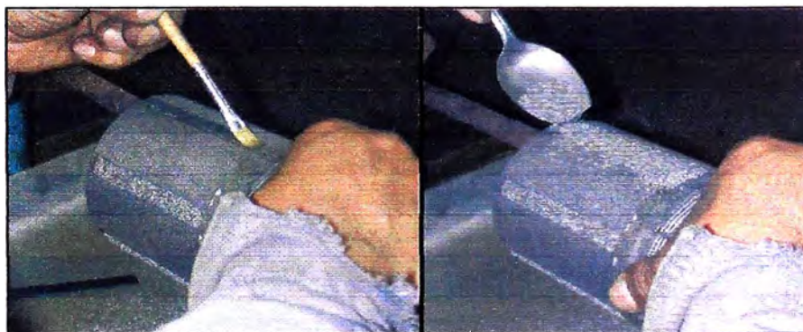
Figura 5.1.5.1._ Preparación de los segmentos de refuerzo. Izquierda: Aplicación de líquido adhesivo. Derecha: Adición de partículas de carburo de tungsteno.
