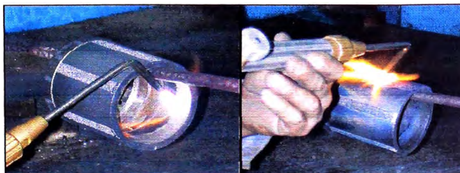
Figura 5.1.5.2._ Proceso de refuerzo. Izquierda: Precalentamiento de la pieza. Derecha: Quemado del refuerzo de carburo de tungsteno.
