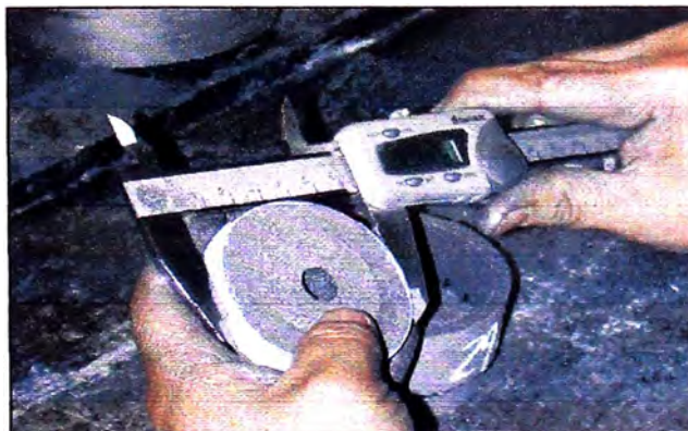
Figura 5.1.1.2._ Fabricación y preparación del centrador.
