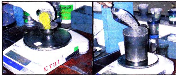
Figura 5.1.2.1._ Derecha: Pesado de matriz. Izquierda: Pesado de polvo de diamante.
