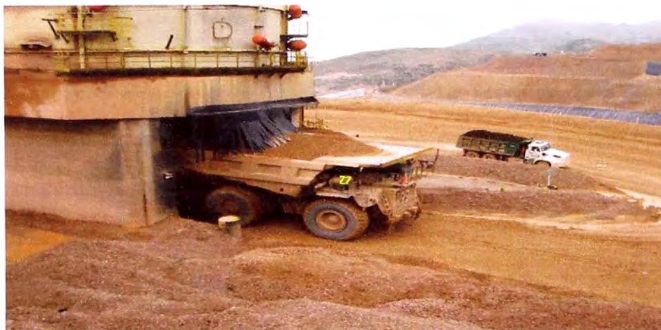
Fig. 1.2 Mineral que esta siendo trasladado al Pad de Lixiviación
