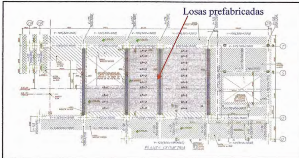
Figura N° 4: Vista en planta del techo (Área =625 m 2 )
