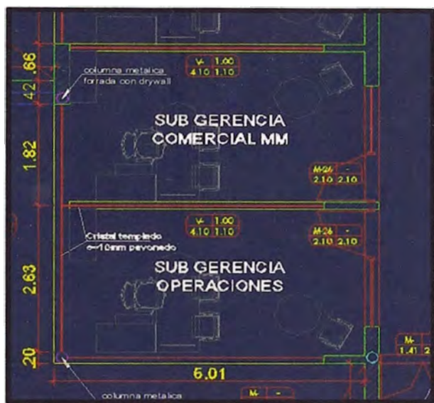
Figura N° 9. Colocación de vanos
