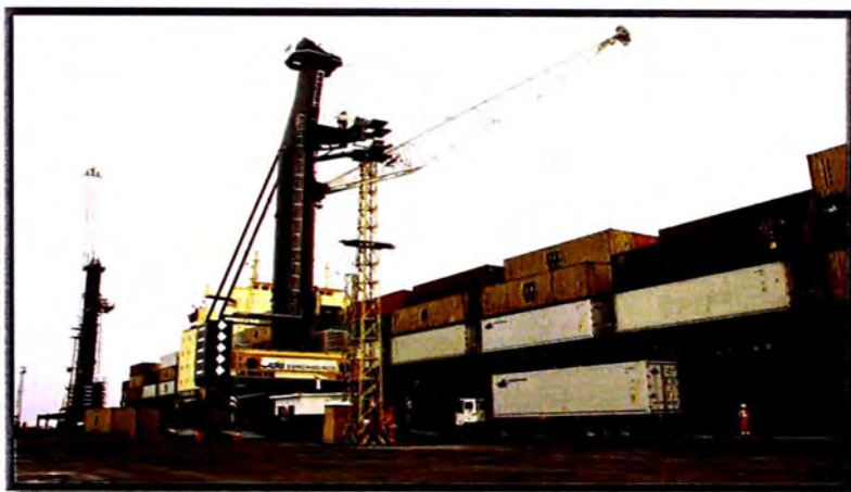
Figura N°2.3 Grúas móviles en el puerto del Callao Elaboración Propia
