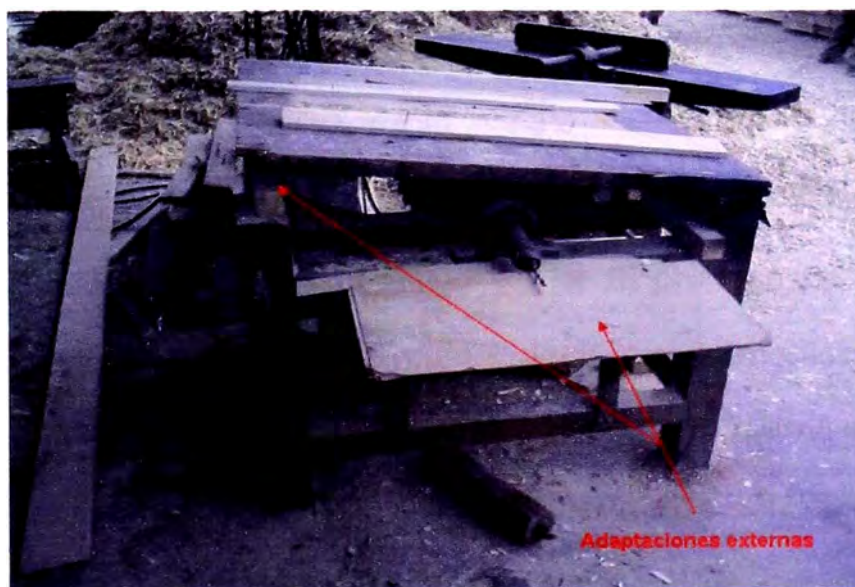
Fig. IV.3.- La circular, muestra adaptaciones externas
