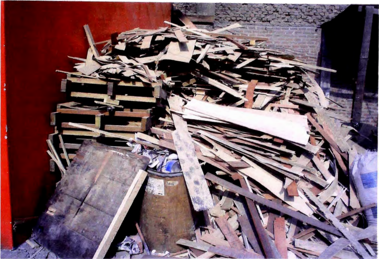
Fig. Nro. V.6.- Chiletas de madera que podrían ser trituradas para la fabricación de tableros y aglomerados
