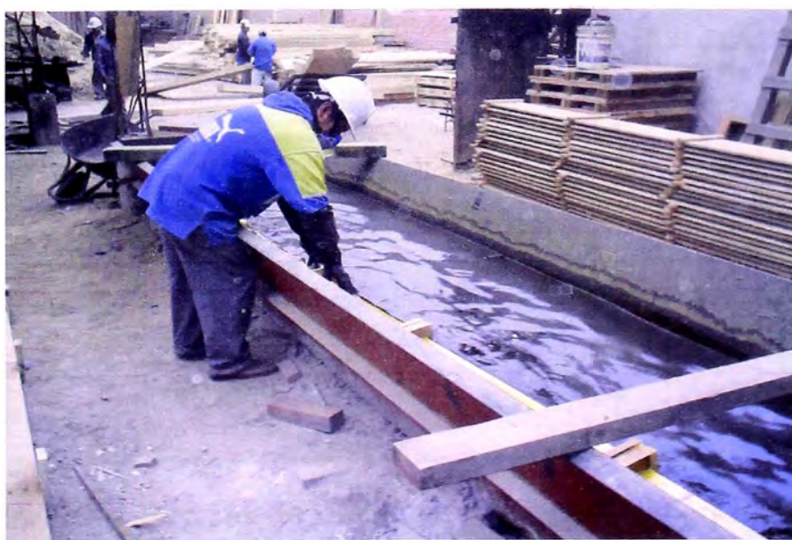
Fig. Nro. V.3.- Tina metálica para curado de embalajes.
