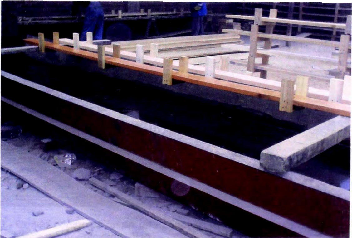
Fig.VI-2.- Tina metálica para preservación de madera por inmersión.
