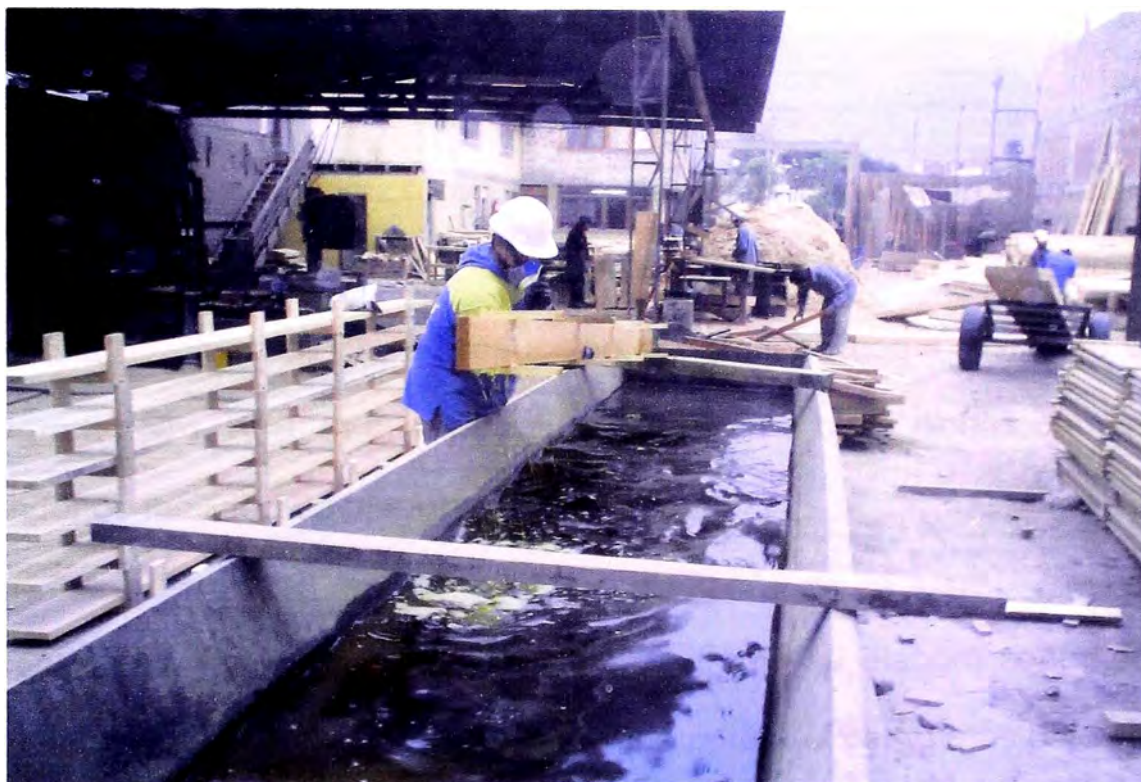
Fig. IV-7.- Curado de embalajes en sales hidrosolubles.
