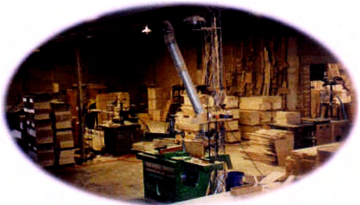
Fig. VI-4.- Sistema de aspirado de aserrín y viruta.
