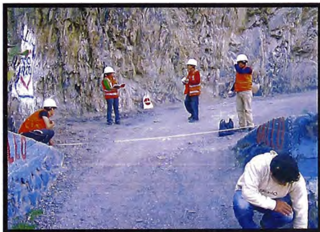
Figura N° 2.2.- Ensayo de refracción sísmica en el margen derecho.
