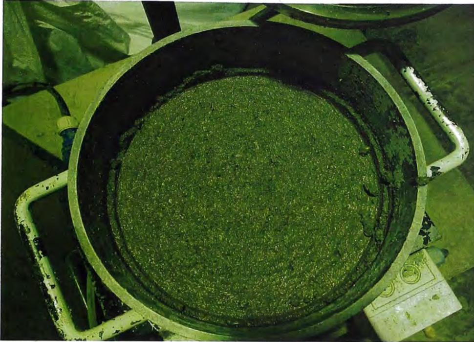
**Figura N° 3.14.- Se observa la formación del anillo de mortero sobre el borde exterior y se determina el tiempo Vebe.**
