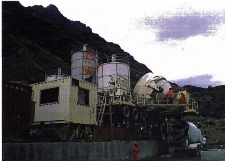
Figura N° 4.3.- Planta de producción para la mezcla del CCR.
