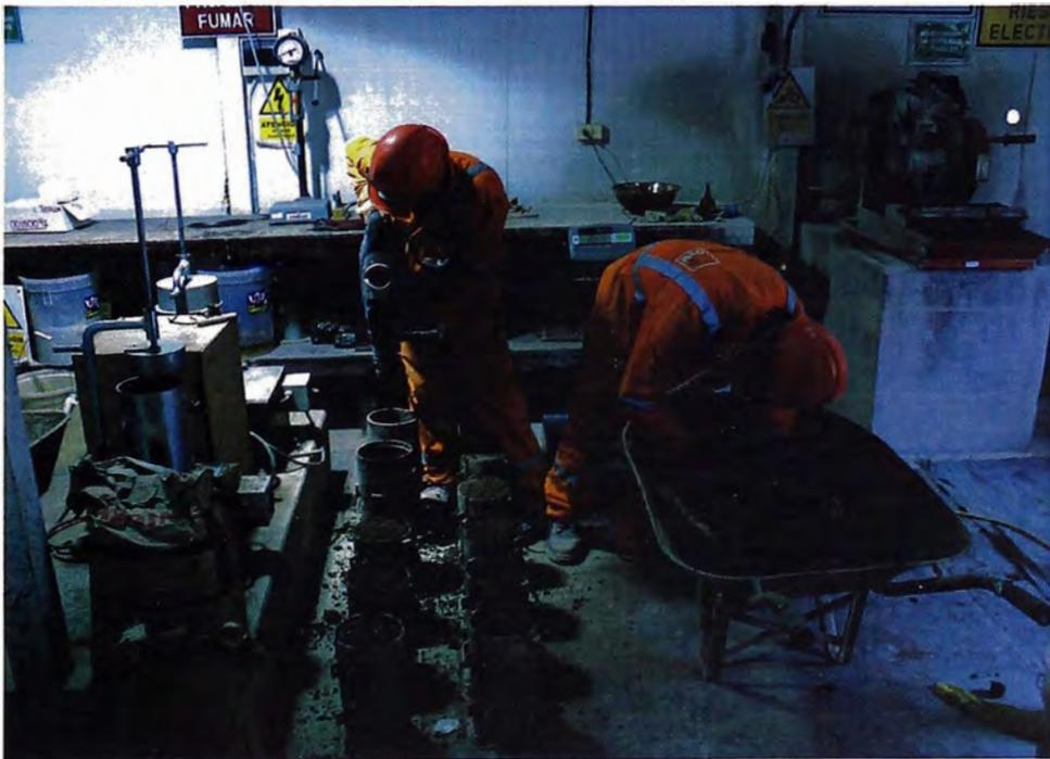
**Figura N° 3.15.- Preparacion de las probetas de concreto en tres capas utilizando el martillo vibratorio.**
