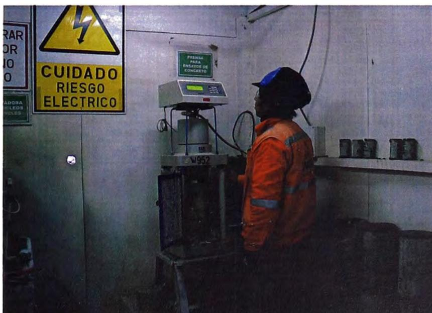
Figura N° 3.20.- Ensayo de resistencia a la compresión de las probetas de CCR a diferentes edades.
