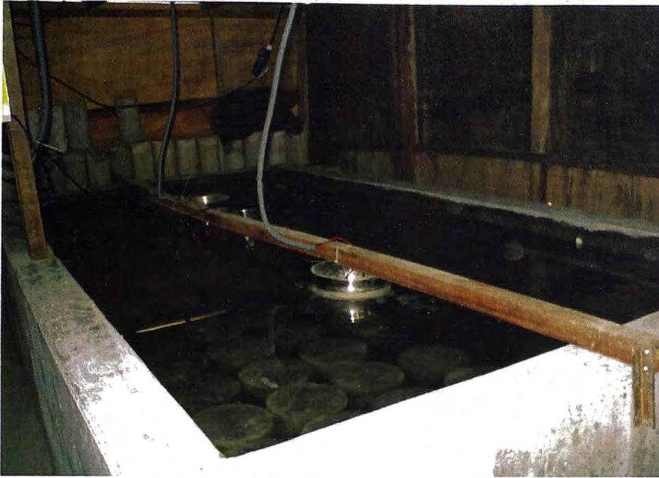
**Figura N° 3.18.- Curado de las probetas de CCR en la poza de agua controlando la temperatura.**
