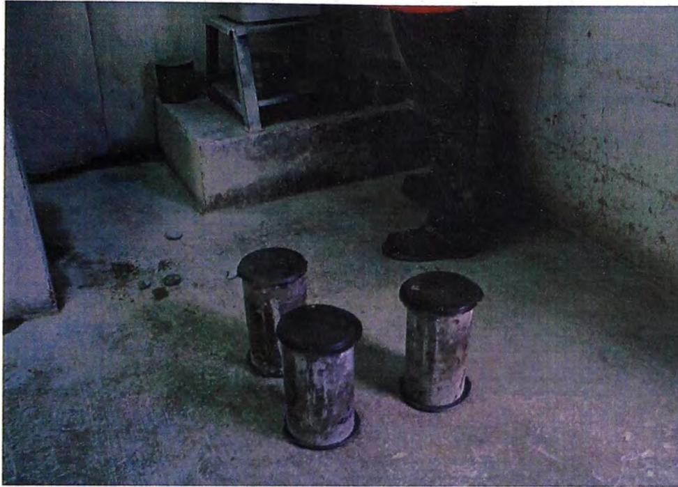
Figura N° 3.19.- Refrentado de las probetas en la cara superior e inferior.
