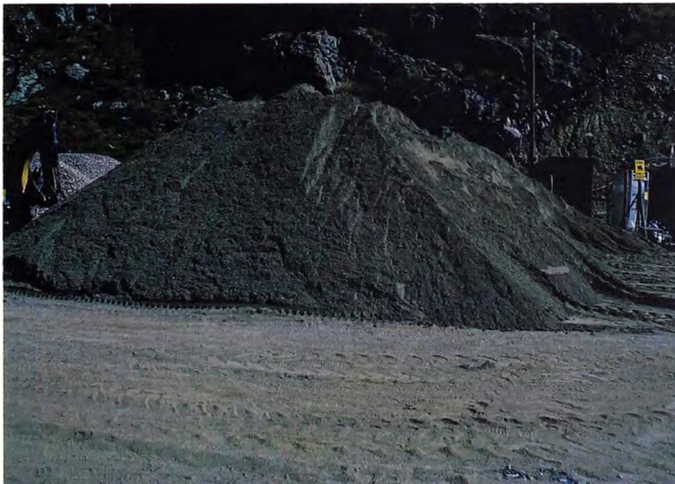
Figura N° 3.7.- Acopio aprobado del agregado fino para el diseño del CCR.
