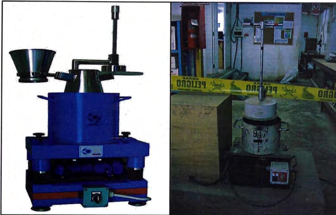
Figura N° 2.5.- Equipo para determinar la c consistencia y el tiempo Vebe.
