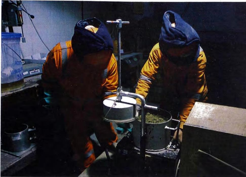
**Figura N° 3.12.- Colocación y nivelación de la mezcla de concreto en el equipo consistometro para determinar el tiempo Vebe.**
