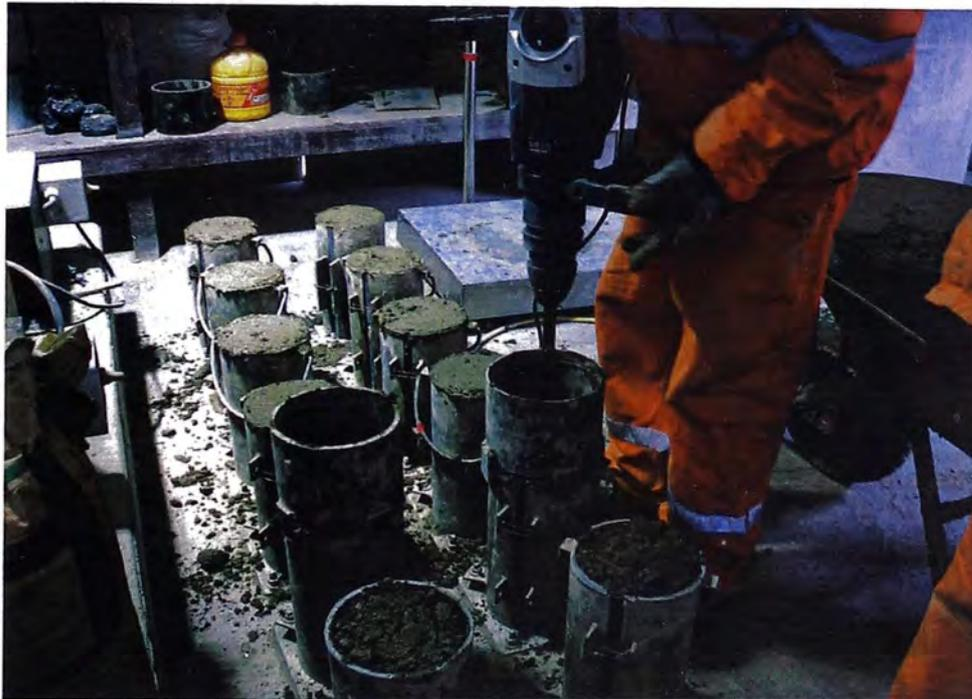
**Figura N° 3.16.- Compactación de la última capa con un collarín encima del borde superior del molde y compactando con el martillo vibratorio.**
