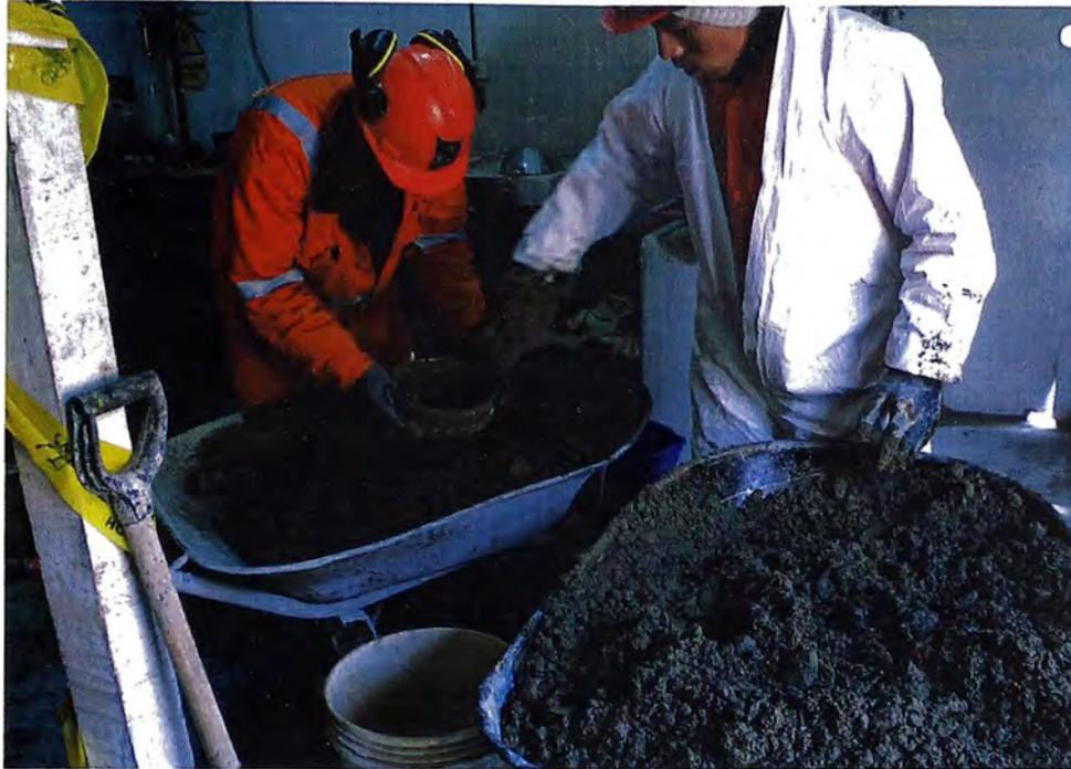
**Figura N° 3.11.- Tamizado de la mezcla con el tamiz de 2 pulg. para el ensayo de consistencia y elaboración de las probetas.**
