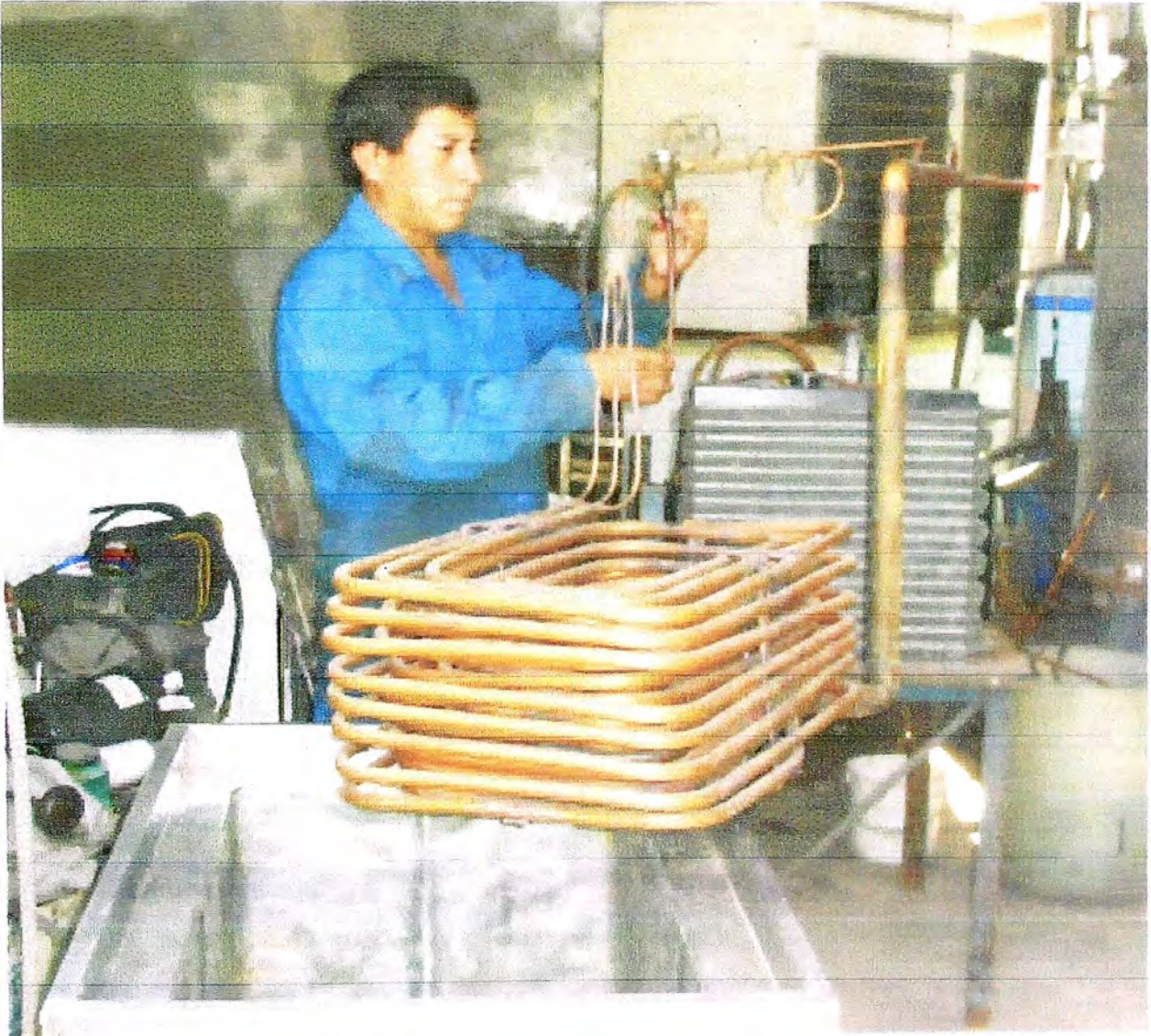
FOTO N° 3 MONTAJE DE LA VALVULA DE EXPANSION
