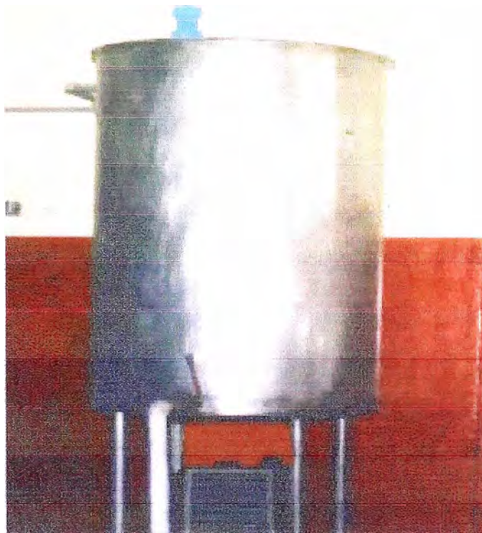
Figura N° 2.3: TANQUE DE MADURACION
