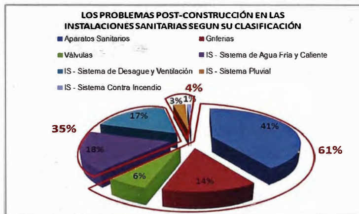
Figura 5 : Problemas en los IISS post construcción
