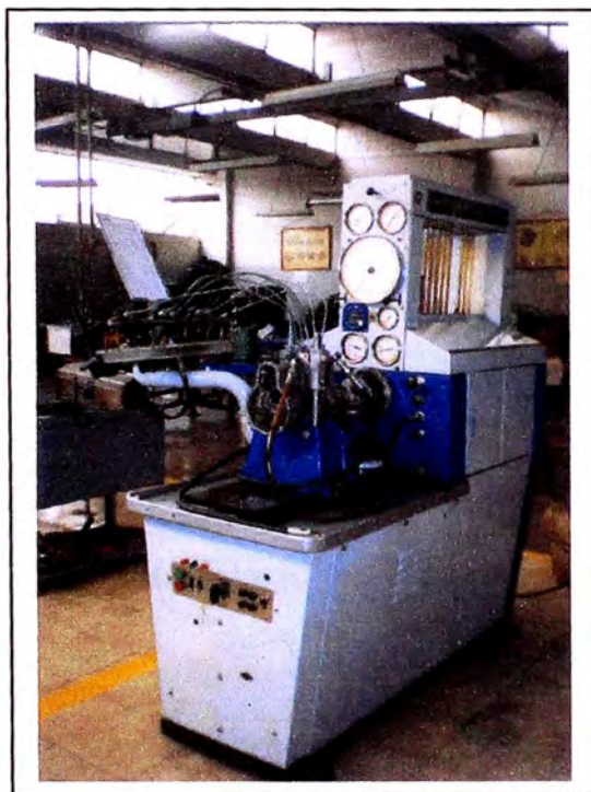
Banco de pruebas hatridge 1100 con 8 inyectores
