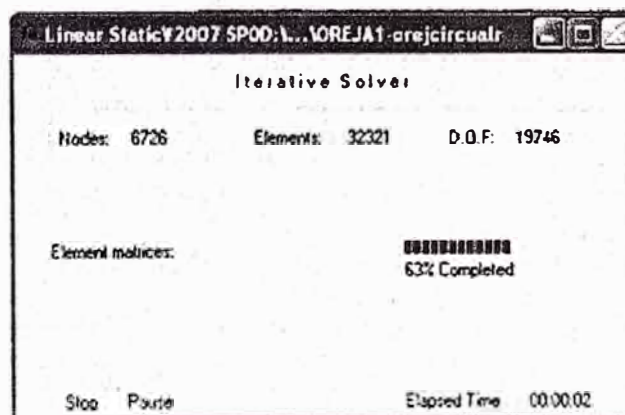
Fig. 3.49 Ventana que muestra la ejecución del programa para: 6 726 nodos, 32 321 elementos y 19 746 grados de libertad.
