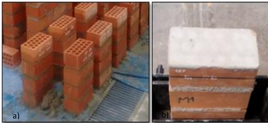
Figura N° 23: Muestras de pilas de albañilería (a); espécimen refrentado para de ensayo de compresión axial en pilas de albañilería (b)
