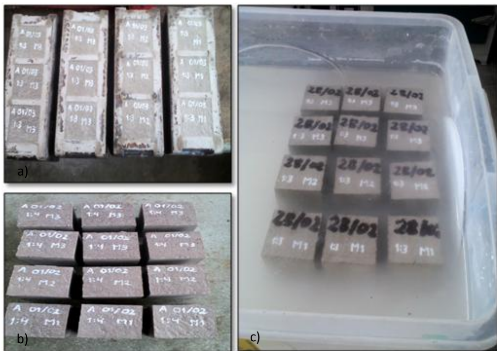
Figura N° 16: Muestras de mortero a las 24 horas de vaciado(a); desencofrado de los cubos de mortero (b); curado de los cubos de mortero (d)
