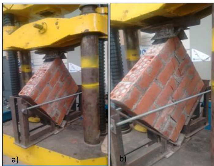
Figura N° 25: Colocado del murete en la máquina universal (a); inicio de la falla en compresión diagonal (b)
