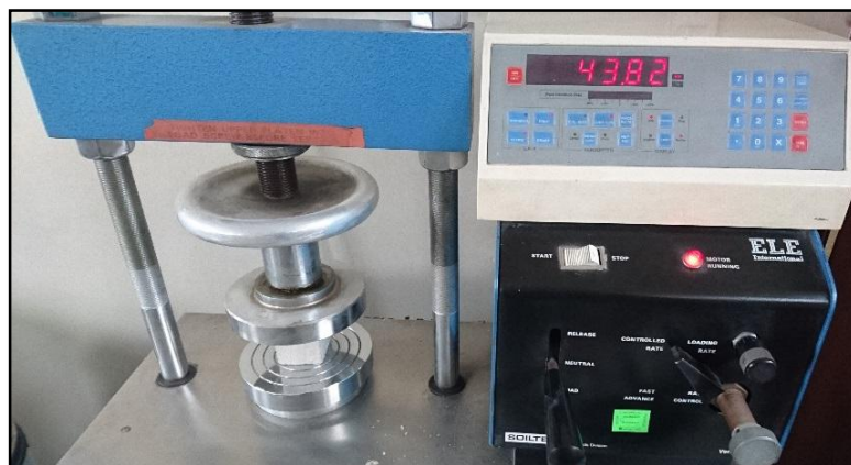
Figura N° 17: Aplicación de carga al espécimen de mortero.
