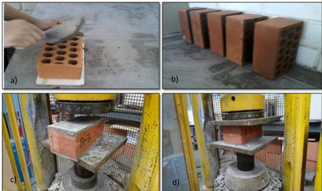
Figura N° 12: Llenado de agujeros en la unidad con mortero (a); secado de las unidades de temperatura ambiente (b); colocado de la unidad en la máquina de compresión (c); ensayo de compresión en unidades de albañilería (d)
