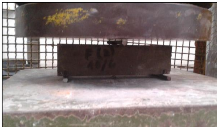
Figura N° 20: Posicionamiento y aplicación de carga mediante apoyo medio en el ensayo resistencia a la flexión
