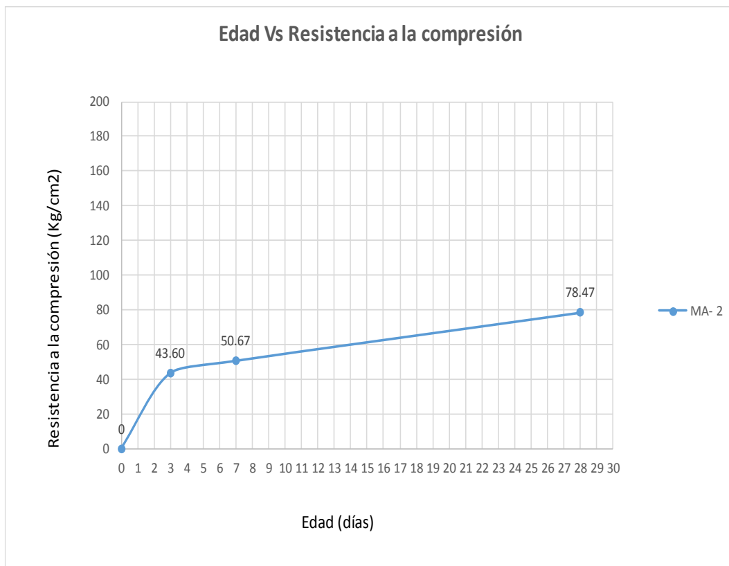
Gráfico N° 11: Resistencia a la compresión en cubos de mortero MA- 2
