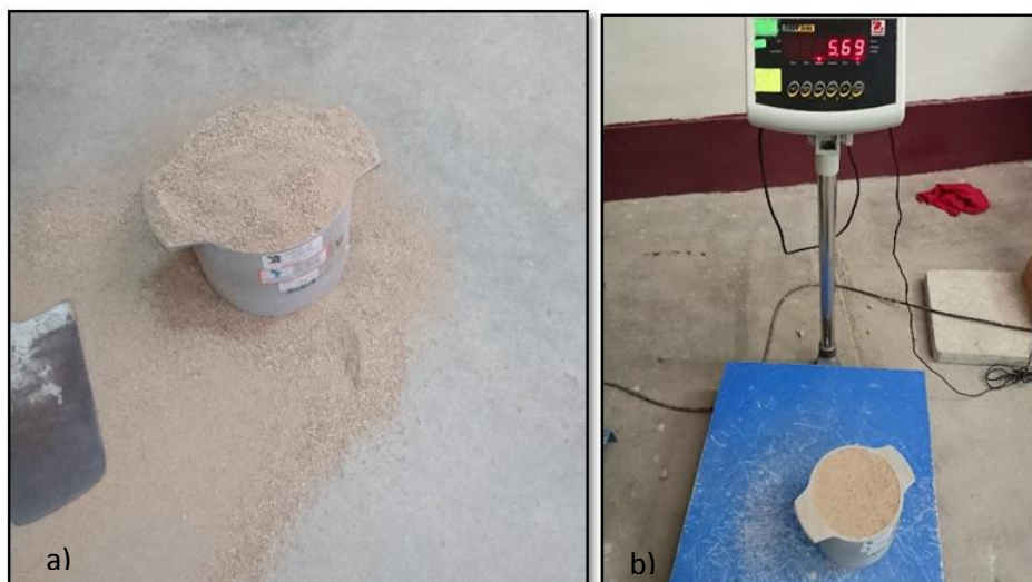
Figura N° 6: Llenado de arena al recipiente de 1/10 pie 3 (a); pesado de recipiente más arena para determinar el P.U.S del agregado fino (b)
