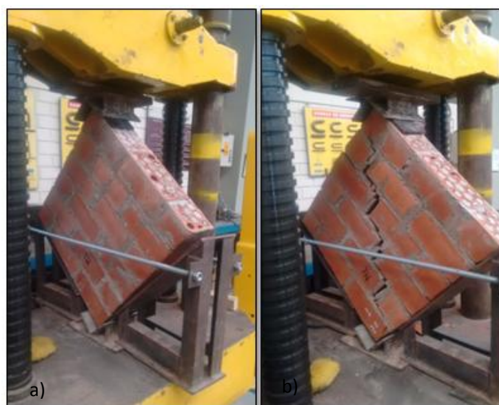
Figura N° 26: Colocado del murete en la máquina universal (a); falla por junta del murete en compresión diagonal (b)
