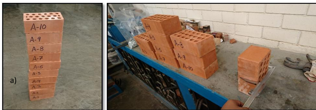
Figura N° 9: Muestras de ladrillo King Kong 18H para ensayo de variación dimensional (a); medición de dimensiones con Vernier (b)
