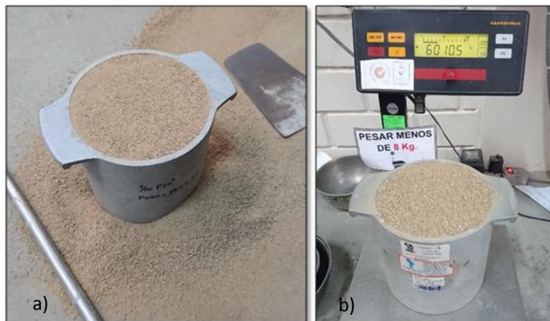
Figura N° 7: Llenado en tres capas de 25 golpes cada capa arena en recipiente de 1/10 pie 3 (a); pesado de recipiente más arena para determinar el P.U.C del agregado fino (b)
