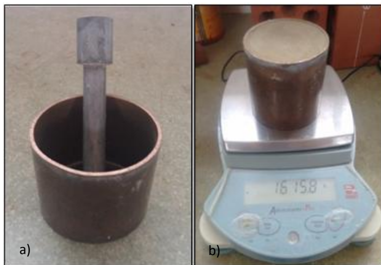
Figura N° 15: Recipiente metálico y pistón (a); pesado para determinar el peso unitario compactado del mortero (b)
