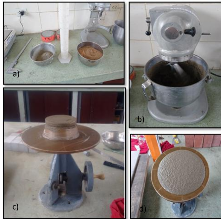
Figura N° 14: Pesado del cemento, arena y agua (a); mezclado de mortero (b); colocado del moro en el cono (c); obtención de la fluidez del mortero (d)
