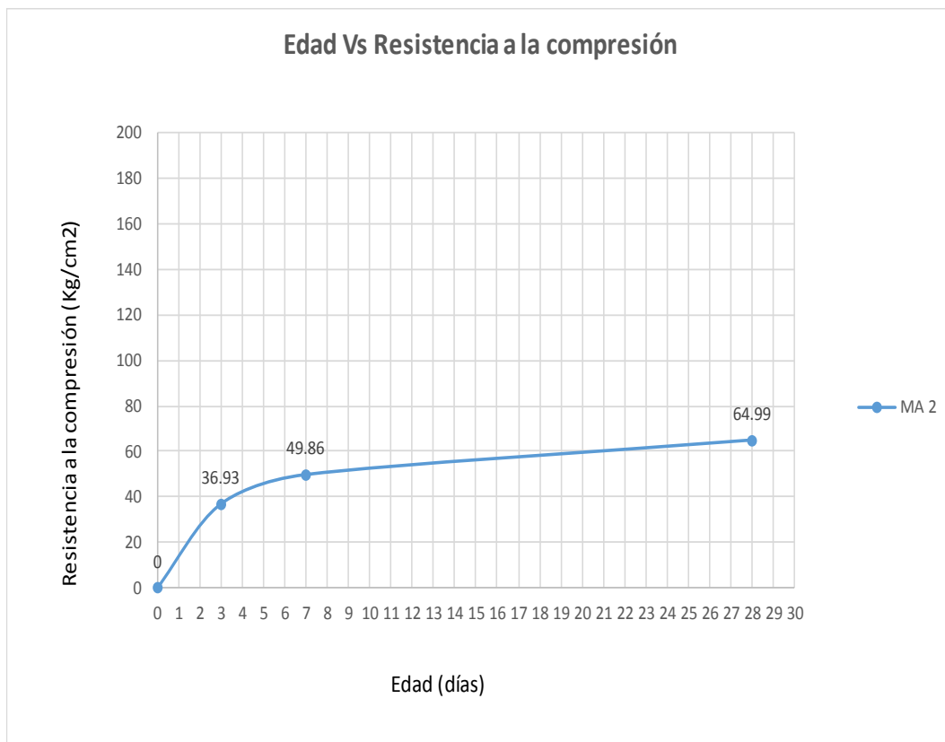
Gráfico N° 12: Resistencia a la compresión en cubos de mortero MA 2
