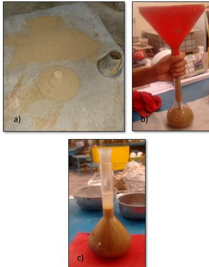
Figura N° 5: Arena saturada superficialmente seca (a); vaciado de la arena superficialmente seca en la fiola (b); sumergido de la arena superfinamente seca en agua (c)
