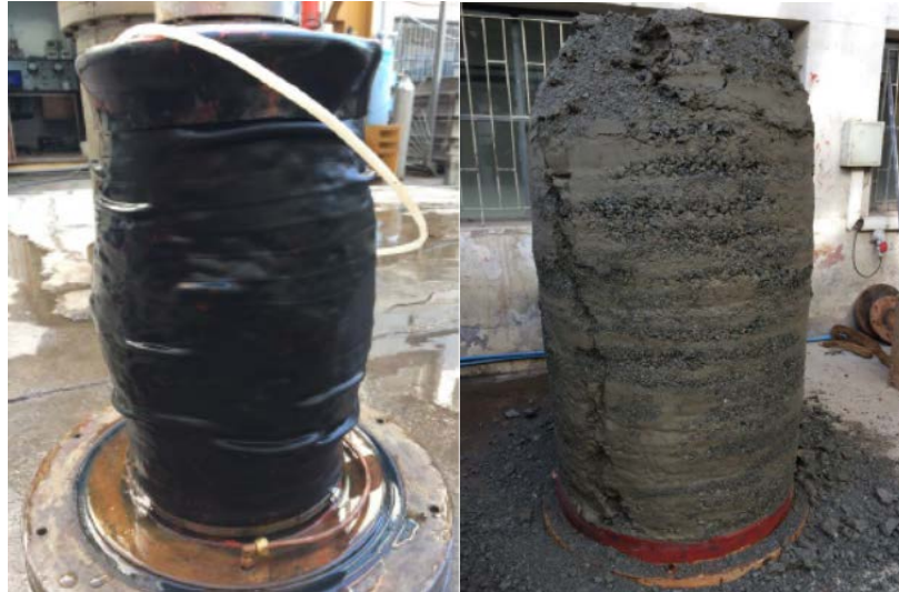
Figura 4.3 Probetas para ensayo triaxial a gran escala del enrocado
