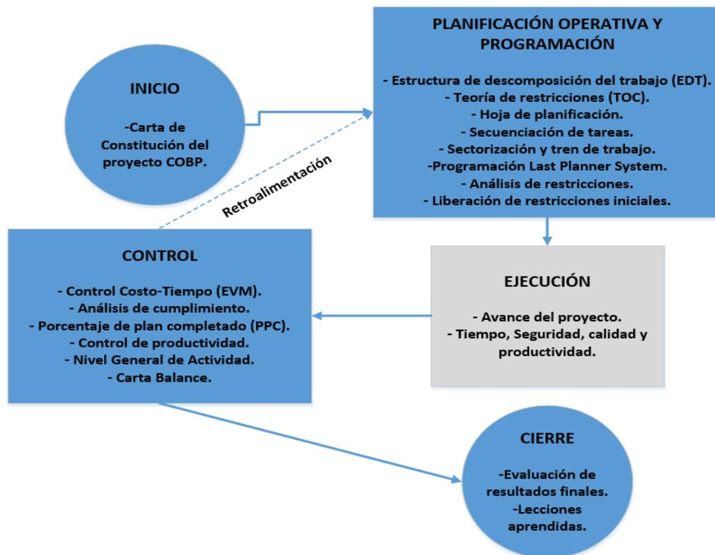
Figura N° 57 Esquema de etapas del proyecto COBP (Ejecución).<sup>98</sup>
