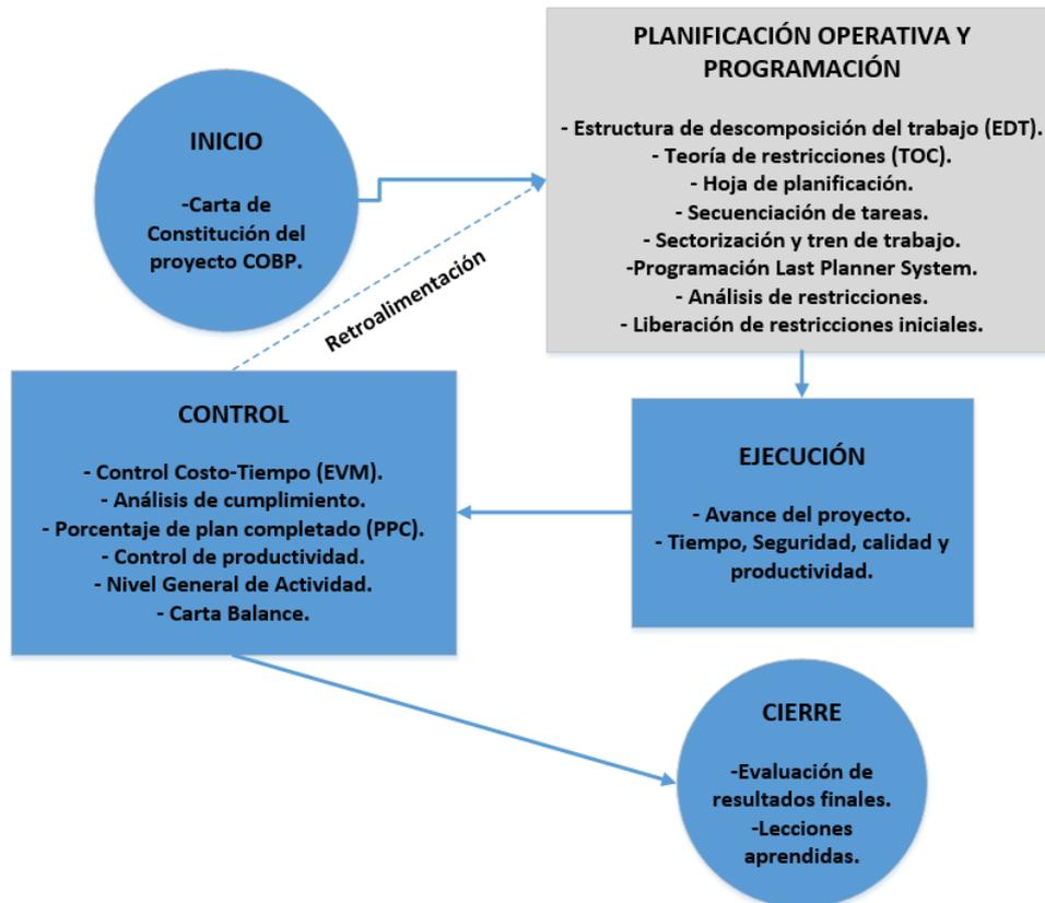
Figura N° 35 Esquema de etapas del proyecto COBP (Planificación operativa y programación).<sup>60</sup>
