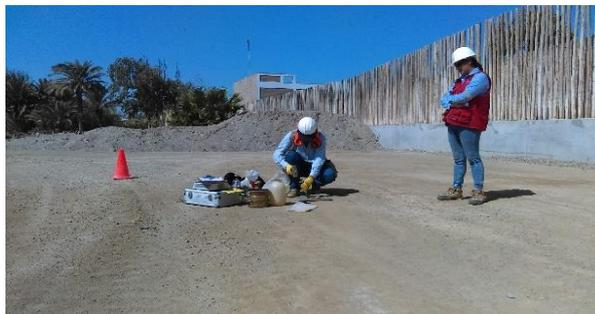
Figura N° 77 Prueba de compactación según normas técnicas.<sup>120</sup>
