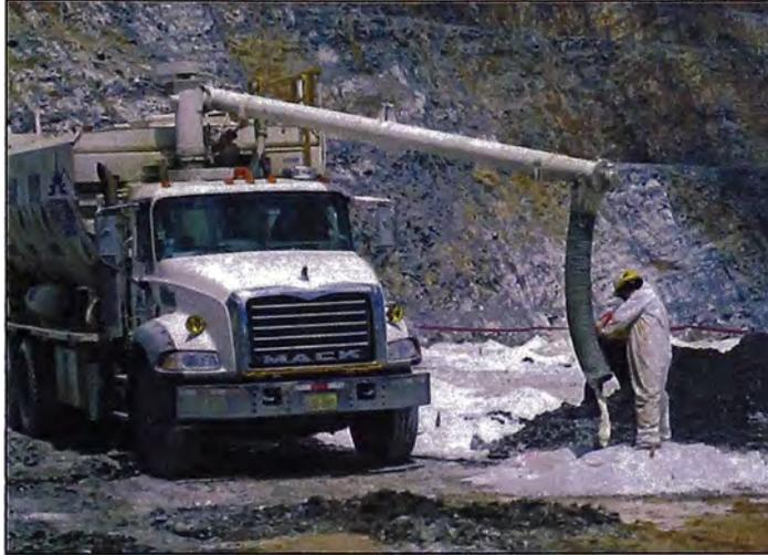
Figura N° 5.- Camión Fabrica Mack cargando taladro
