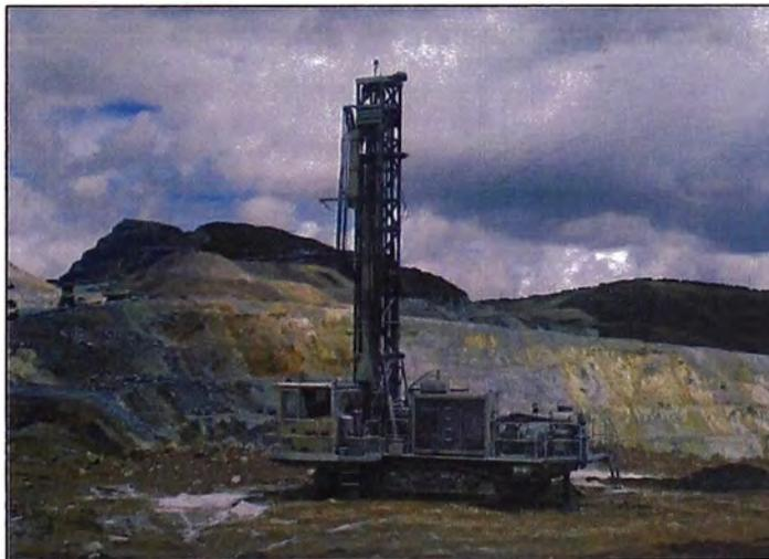
Figura N° 4.- Perforadora Atlas Copco DM45E
