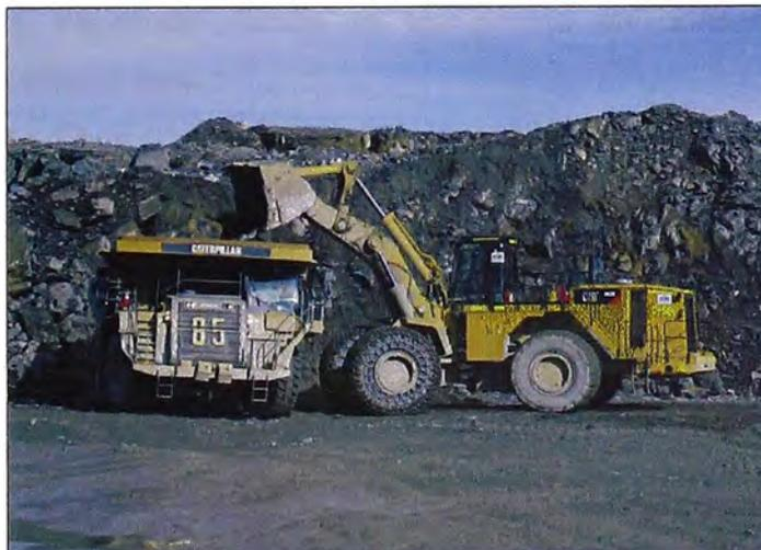
Figura N° 6.- Cargador CAT 992K cargando mineral
