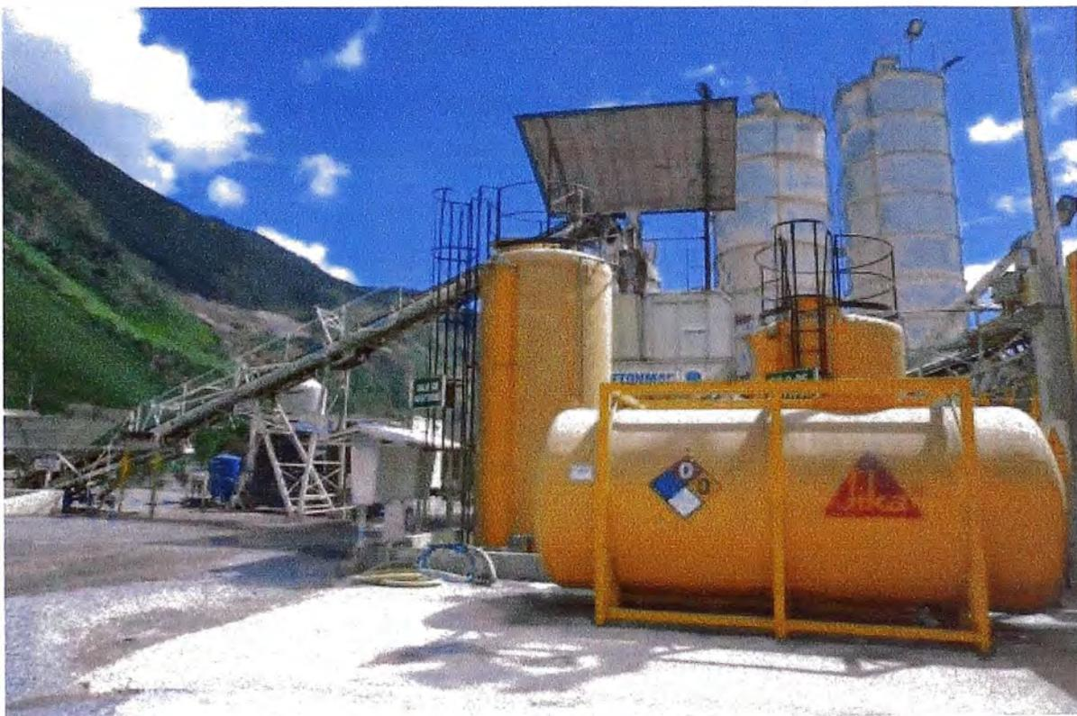
Figura N° 2.4.- Almacenamiento de aditivo a granel en la Planta de concreto
