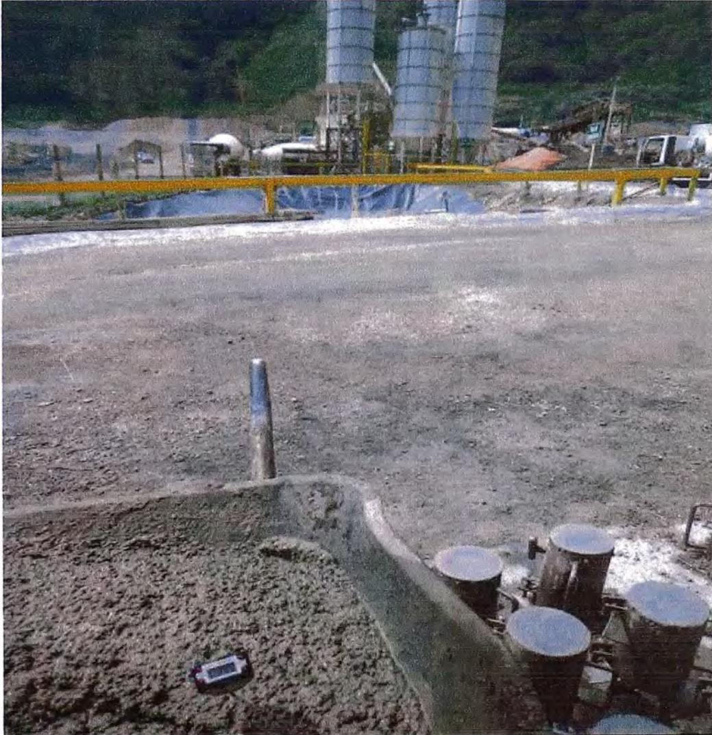
Figura N° 4.1.- Control de la Temperatura del Concreto
