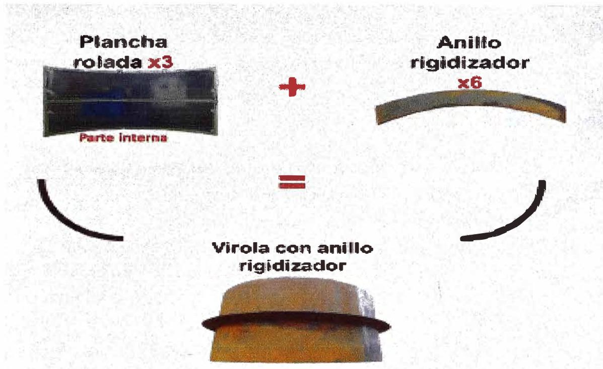
Figura N° 3.2.- Formación de un Tubo de Blindaje
