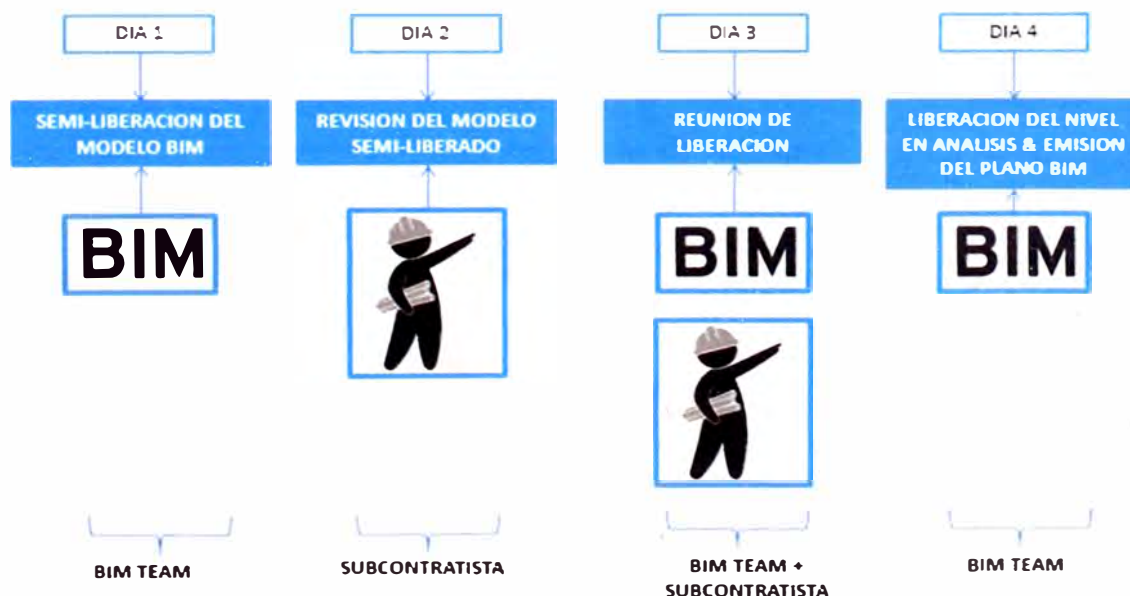
Figura N°5.19: Proceso de Coordinación BIM en la Obra Nueva Sede del Banco de la Nación, Cortesía Cosapi Ingeniería y construcción.
