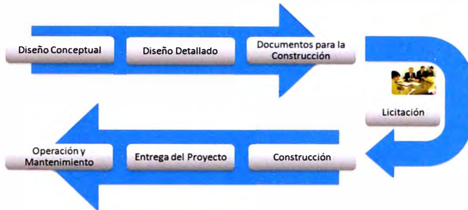
Figura N°1.5: Proceso de desarrollo de proyectos de construcción basados en el sistema Diseño / Licitación / Construcción
