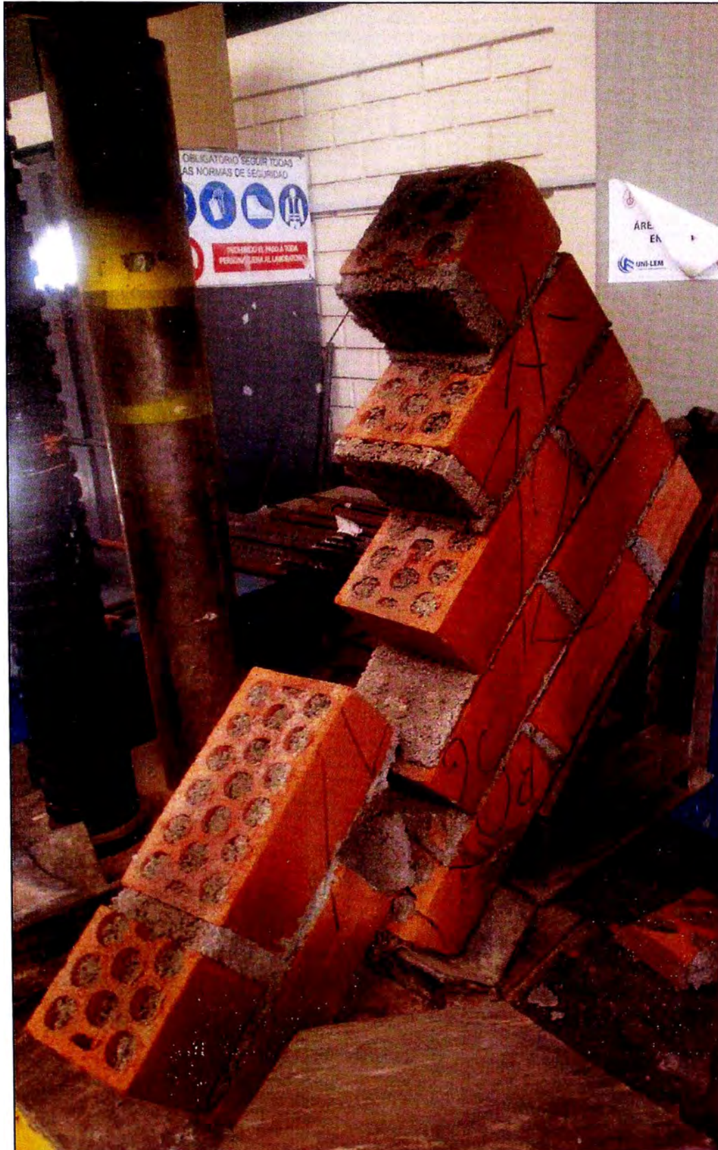
Anexo N° 12: MODO DE FALLA DE MURETE ELABORADO CON MORTERO CONCREMAX MEZCLADO CON MENOR CANTIDAD DE AGUA QUE LO RECOMENDADO EN SUS ESPECIFICACIONES.
