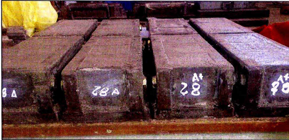
Figura N° 18: Llenado y enrasado de moldes cúbicos de 50 mm de lado.
