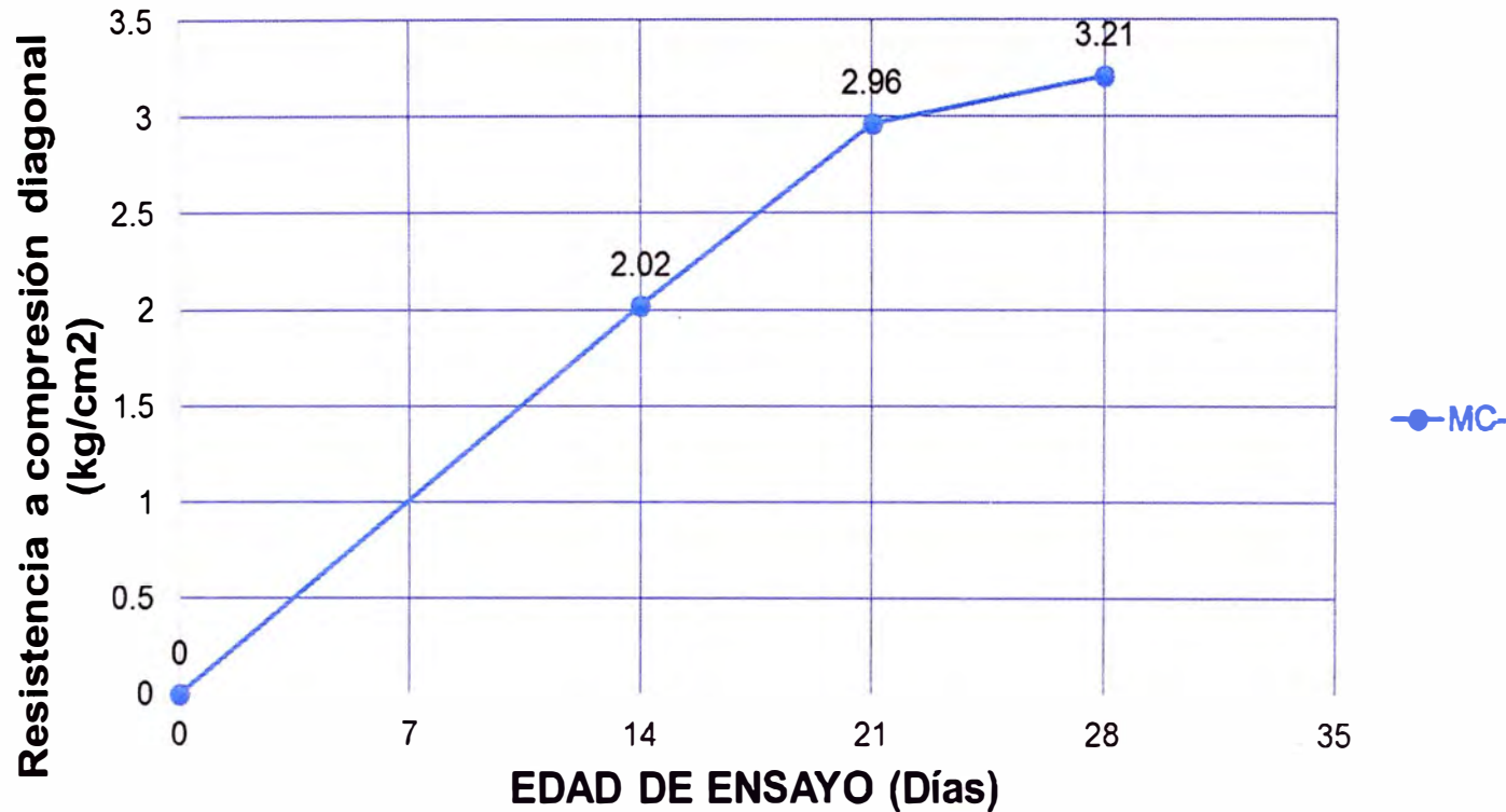
Gráfico N° 17: Edad de ensayo vs Resistencia a compresión diagonal de muretes elaborados con MORTERO CONCREMAX – Característica: Ladrillo KK 18H, MORTERO CONCREMAX agua de diseño: 5 Litros por 40 Kg de producto.
