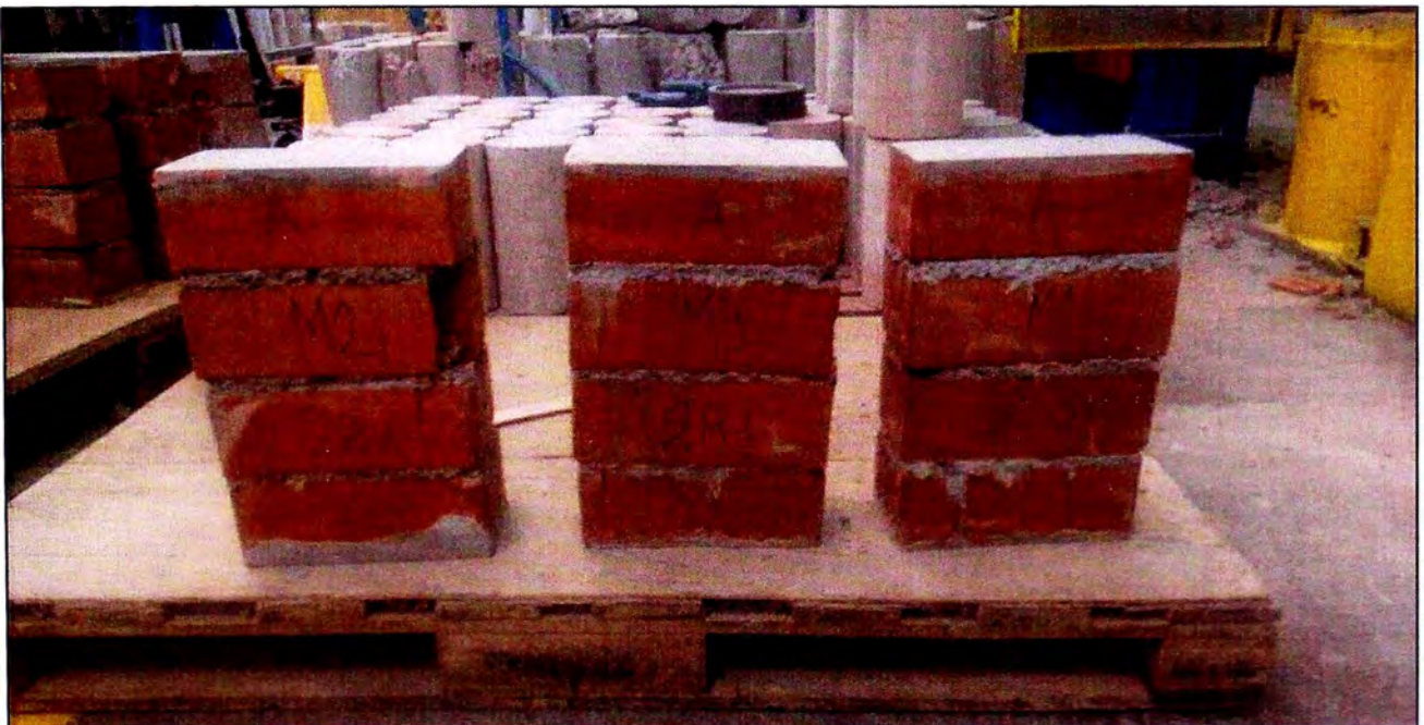
Anexo N° 9: MODO DE FALLA DE PILAS ELABORADAS CON MORTERO CONCREMAX MEZCLADO CON IGUAL CANTIDAD DE AGUA QUE LO RECOMENDADO EN SUS ESPECIFICACIONES.
