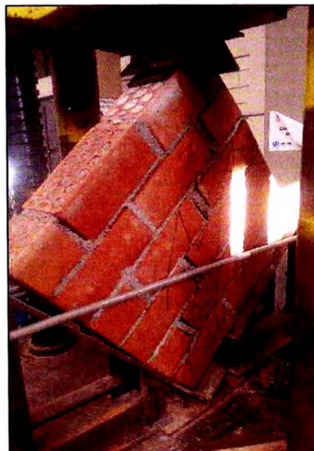
Figura N° 33: Modo de falla del murete en el ensayo de compresión diagonal a los 28 días, empleando el mortero embolsado mezclado con 5 Litros de agua por 40 Kg de producto.
