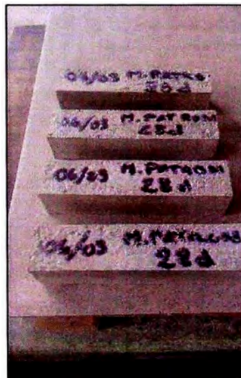
Figura N° 23: Especímenes prismáticos de 40x40x160 mm de lado para determinar la resistencia a la flexión del mortero.
