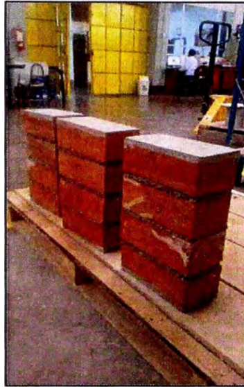
Figura N° 28: Muestra de pilas de albañilería para ensayo de compresión axial.
