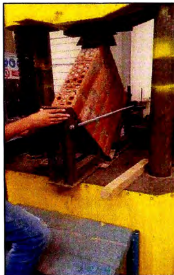
Figura N° 30: Colocación del murete de albañilería, con la diagonal del murete en dirección paralela a la gravedad.
