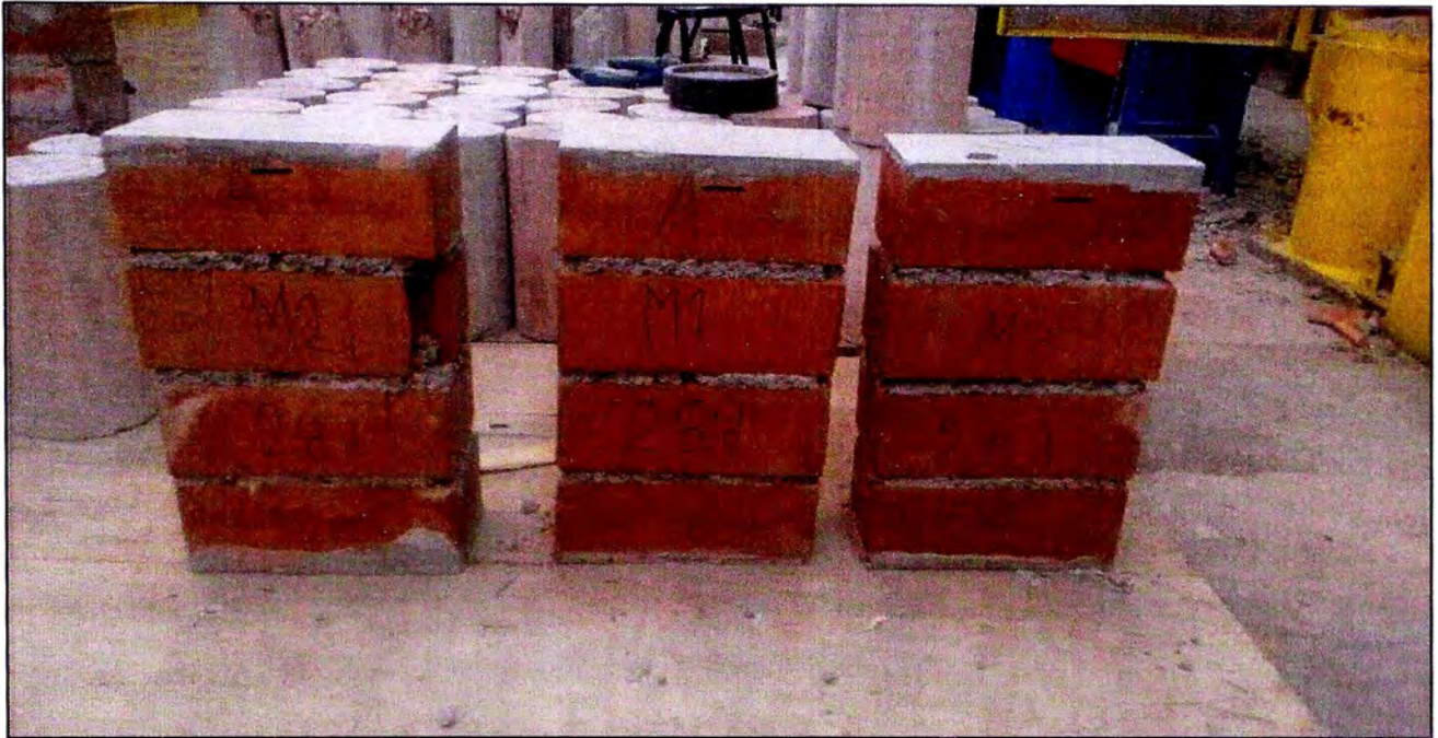
Anexo N° 8: MODO DE FALLA DE PILAS ELABORADAS CON MORTERO CONCREMAX MEZCLADO CON MENOR CANTIDAD DE AGUA QUE LO RECOMENDADO EN SUS ESPECIFICACIONES.
