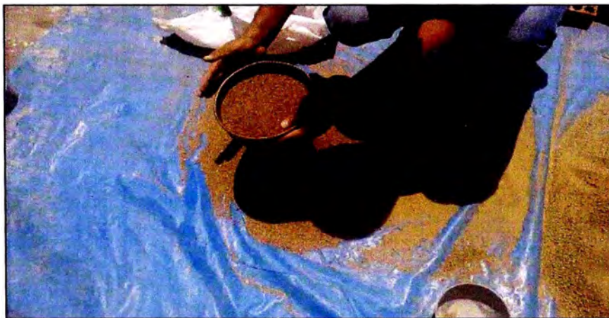
Anexo N° 4: AGREGADO FINO PARA LA ELABORACIÓN DEL MORTERO PATRÓN, TAMIZADO DE LA ARENA CON LA MALLA N° 8.
