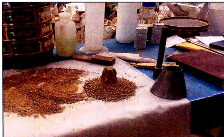
Figura N° 12: Muestra del agregado fino Saturado Superficialmente Seco (SSS).
