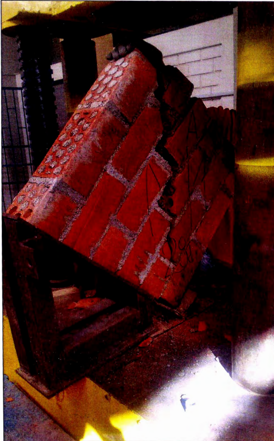
Anexo N° 13: MODO DE FALLA DE MURETE ELABORADO CON MORTERO CONCREMAX MEZCLADO CON IGUAL CANTIDAD DE AGUA QUE LO RECOMENDADO EN SUS ESPECIFICACIONES.
