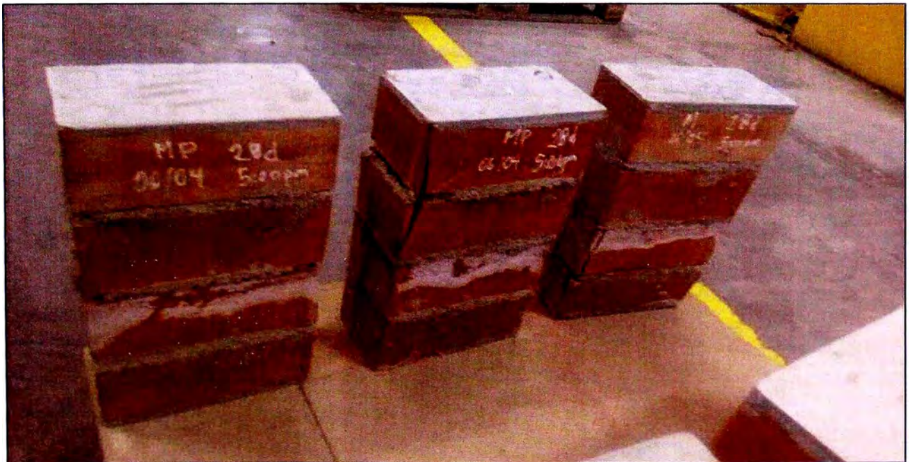
Anexo N° 11: MODO DE FALLA DE PILAS ELABORADAS CON MORTERO PATRÓN.
