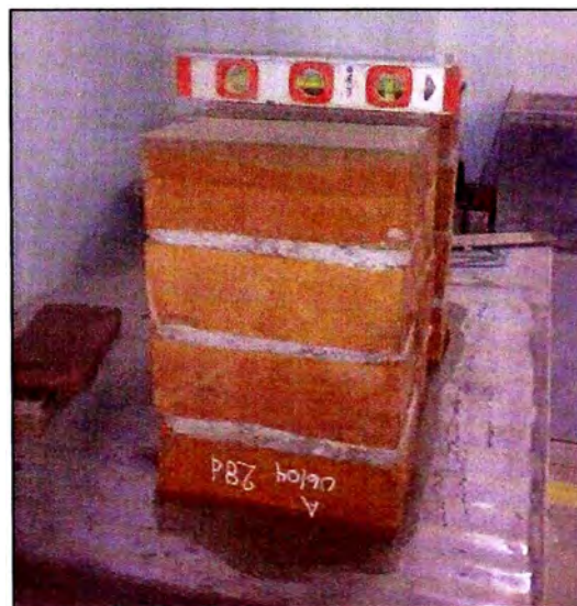
Figura N° 25: Capeado y nivelado de pilas de albañilería.
