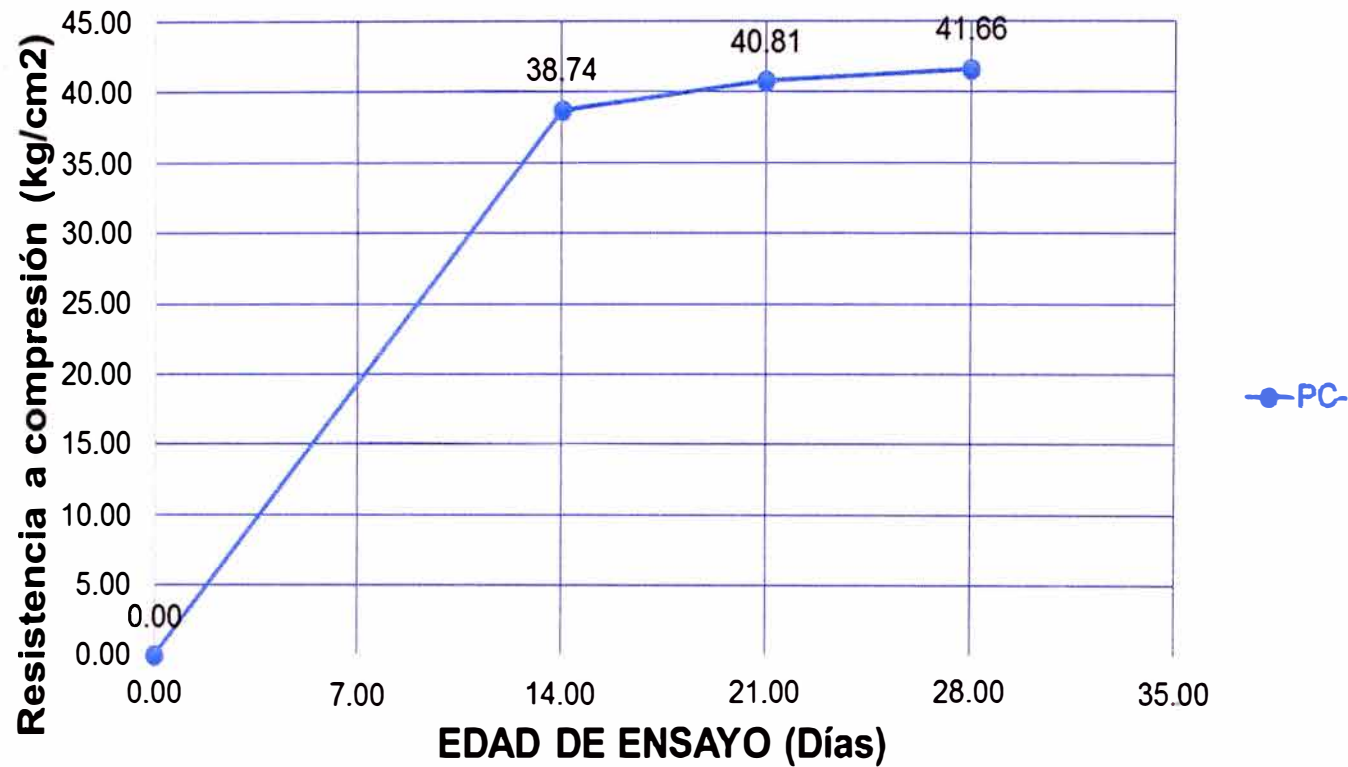
Gráfico N° 12: Edad de ensayo vs Resistencia a compresión de pilas elaboradas con MORTERO CONCREMAX – Característica: Ladrillo KK 18H, MORTERO CONCREMAX agua de diseño: 5 Litros por 40 Kg de producto.
