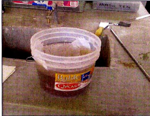
Figura N° 11: Saturación de la muestra de agregado fino durante 24 horas.
