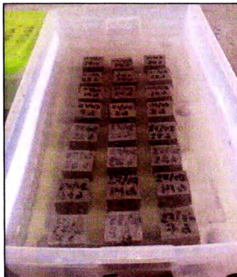
Figura N° 19: Curado de especímenes cúbicos en agua con cal (4gr de cal por litro de agua).
