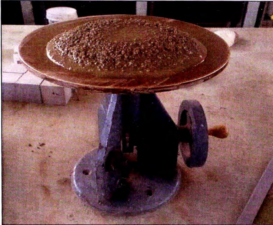
Figura N° 38: Fluidez del mortero CONCREMAX, agua de diseño: 6 Litros por 40 Kg de producto.
