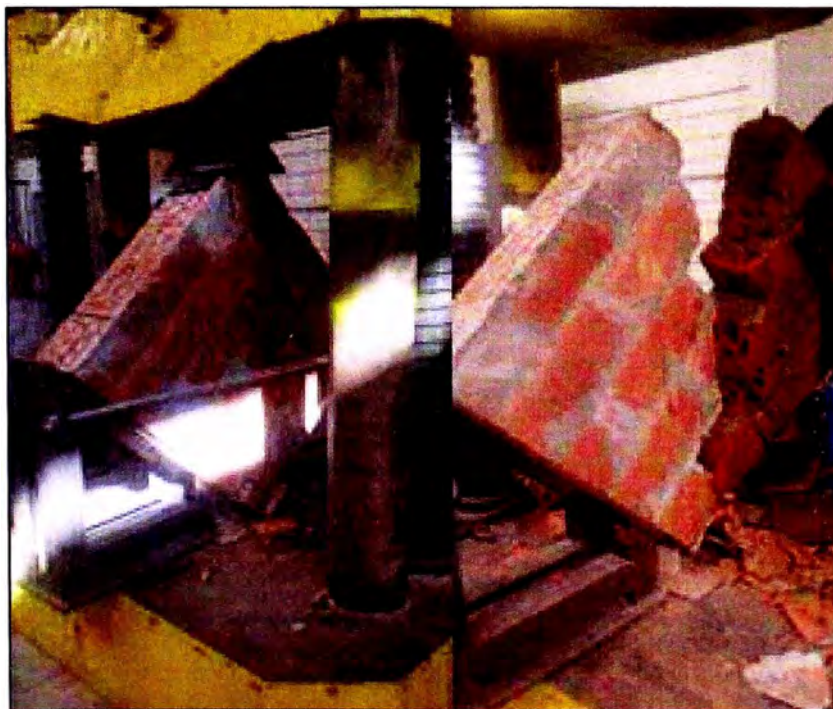
Figura N° 35: Modo de falla del murete en el ensayo de compresión diagonal a los 28 días, empleando el mortero embolsado mezclado con 7 Litros de agua por 40 Kg de producto.
