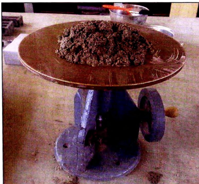
Figura N° 37: Fluidez del mortero CONCREMAX, agua de diseño: 5 Litros por 40 Kg de producto.
