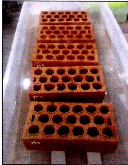
Figura N° 8: Sumersión parcial de las unidades de albañilería.
