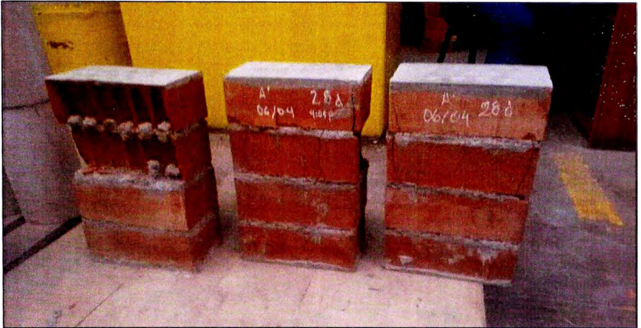
Anexo N° 10: MODO DE FALLA DE PILAS ELABORADAS CON MORTERO CONCREMAX MEZCLADO CON MAYOR CANTIDAD DE AGUA QUE LO RECOMENDADO EN SUS ESPECIFICACIONES.
