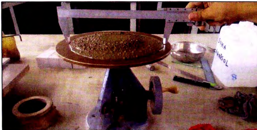
Figura N° 16: Llenado de tronco de cono de 10.16 cm de base sobre la mesa de flujo (1), medición de diámetro luego de realizado los 25 golpes (2).
