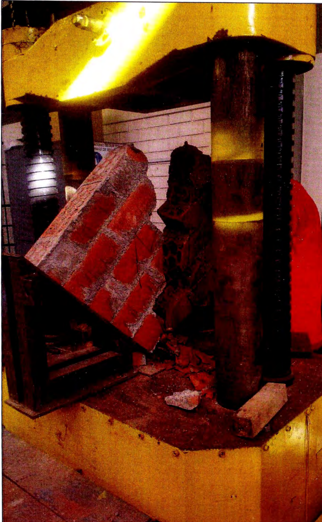
Anexo N° 14: MODO DE FALLA DE MURETE ELABORADO CON MORTERO CONCREMAX MEZCLADO CON MAYOR CANTIDAD DE AGUA QUE LO RECOMENDADO EN SUS ESPECIFICACIONES.
