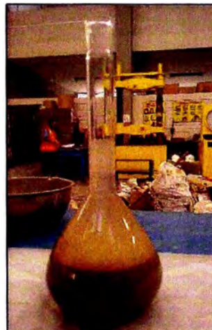
Figura N° 14: Llenado con agua del volumen total de la fiola para determinar el peso total del agua en el frasco.
