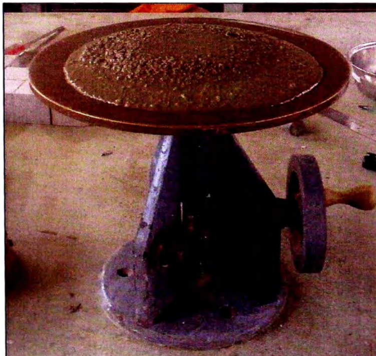
Figura N° 39: Fluidez del mortero CONCREMAX, agua de diseño: 7 Litros por 40 Kg de producto.
