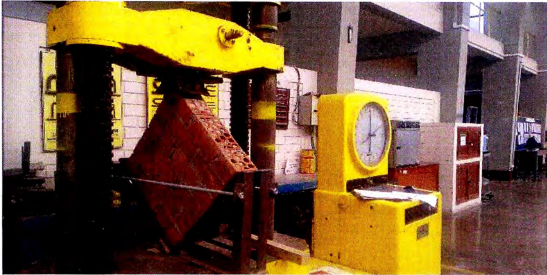
Figura N° 31: Aplicación de carga de compresión diagonal sobre el murete.
