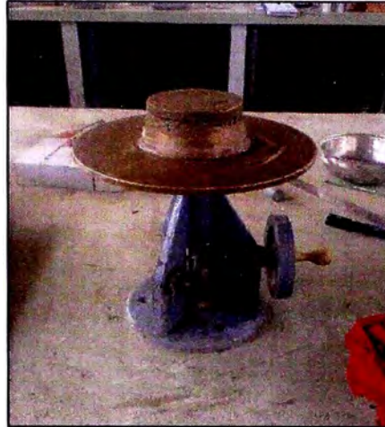
Figura N° 15: Llenado de tronco de cono de 10.16 cm de base sobre la mesa de flujo.
