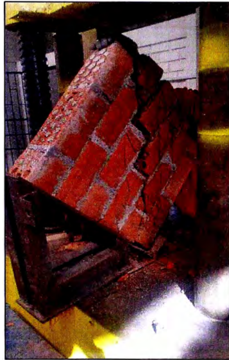
Figura N° 34: Modo de falla del murete en el ensayo de compresión diagonal a los 28 días, empleando el mortero embolsado mezclado con 6 Litros de agua por 40 Kg de producto.
