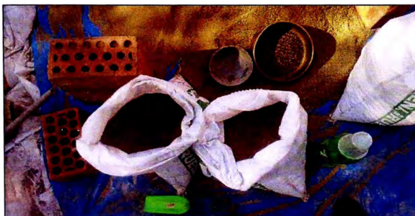
Anexo N° 5: AGREGADO FINO PARA LA ELABORACIÓN DEL MORTERO PATRÓN, ELIMINACIÓN DE MATERIAL RETENIDO EN LAS MALLAS N° 4 y N° 8.
