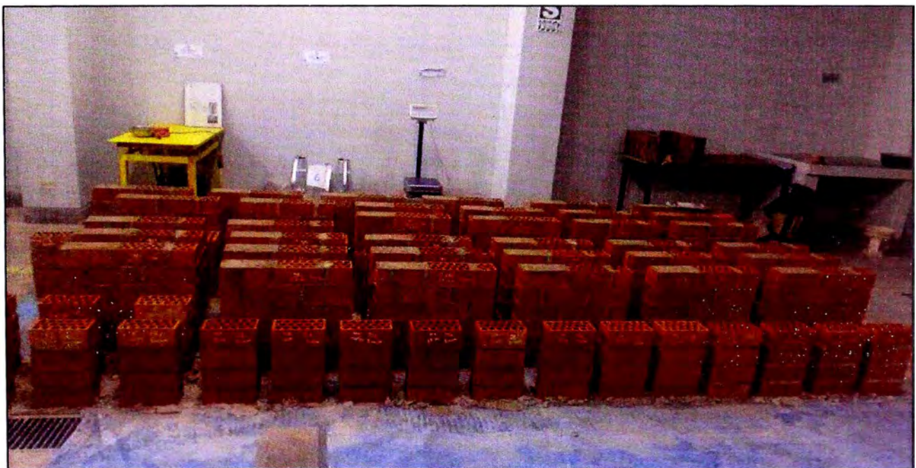
Anexo N° 7: ESPECIMENES DE ENSAYO, TOTAL DE PILAS Y MURETES A ENSAYAR.
