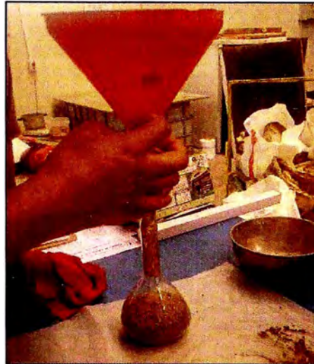
Figura N° 13: Muestra de 500 gr de agregado fino SSS llenado en una fiola de 500 cc.
