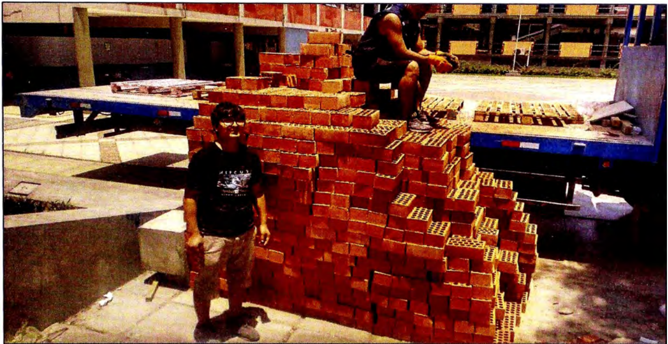
Anexo N° 6: UNIDADES DE ALBAÑILERÍA UTILIZADAS PARA LA ELABORACIÓN DE PILAS Y MURETES, LADRILLOS KING KONG 18 HUECOS DE LA MARCA PIRÁMIDE.
