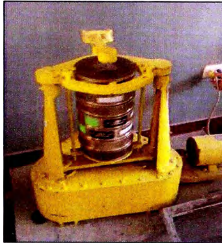
Figura N° 9: Proceso de vibrado del agregado fino.
