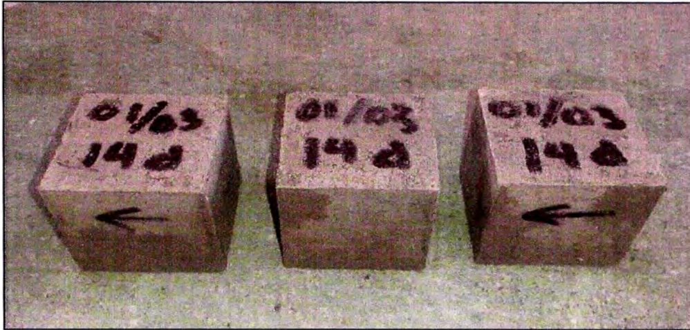
Figura N° 20: Especímenes cúbicos de mortero a ser ensayados a los 14 días de edad.
