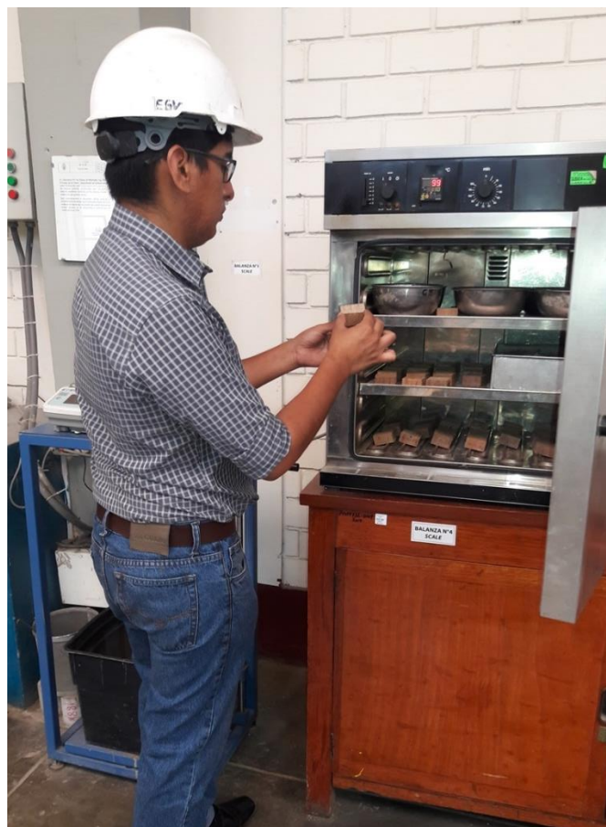
Fig. N° 22 Muestras de las especies Cachimbo Colorado y Capirona puestas al horno
