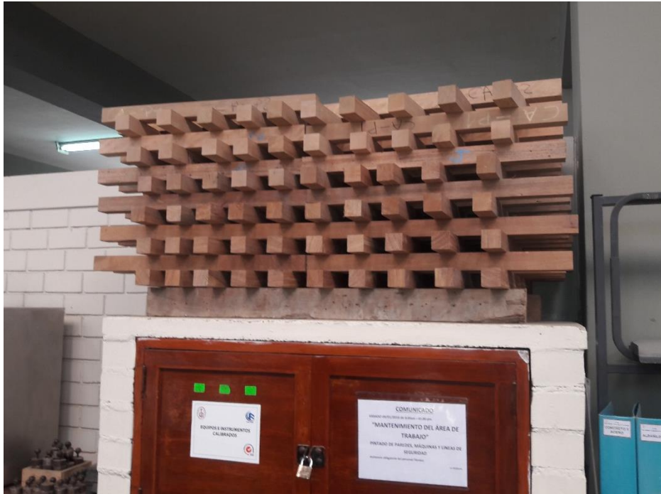
Fig. N° 19 Acondicionamiento para el secado natural de las especies Cachimbo Colorado y Capirona
