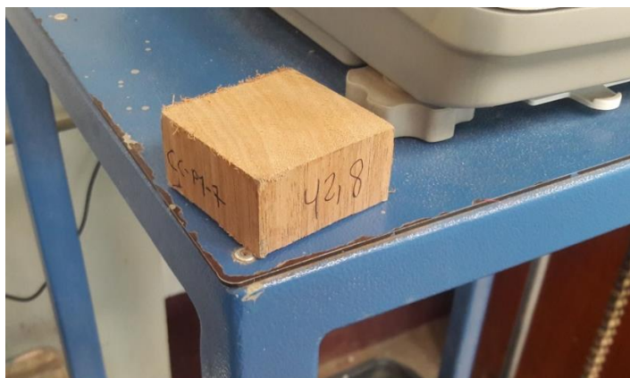
Fig. N° 20 Probeta para el Contenido de Humedad de la especie Cachimbo Colorado obtenida a partir de la probeta de Ensayo a Flexión
