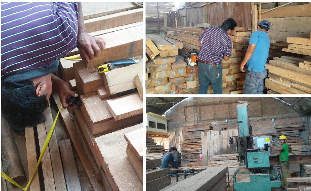
Fig. N° 17 Selección de Troza, identificación y corte de listones
