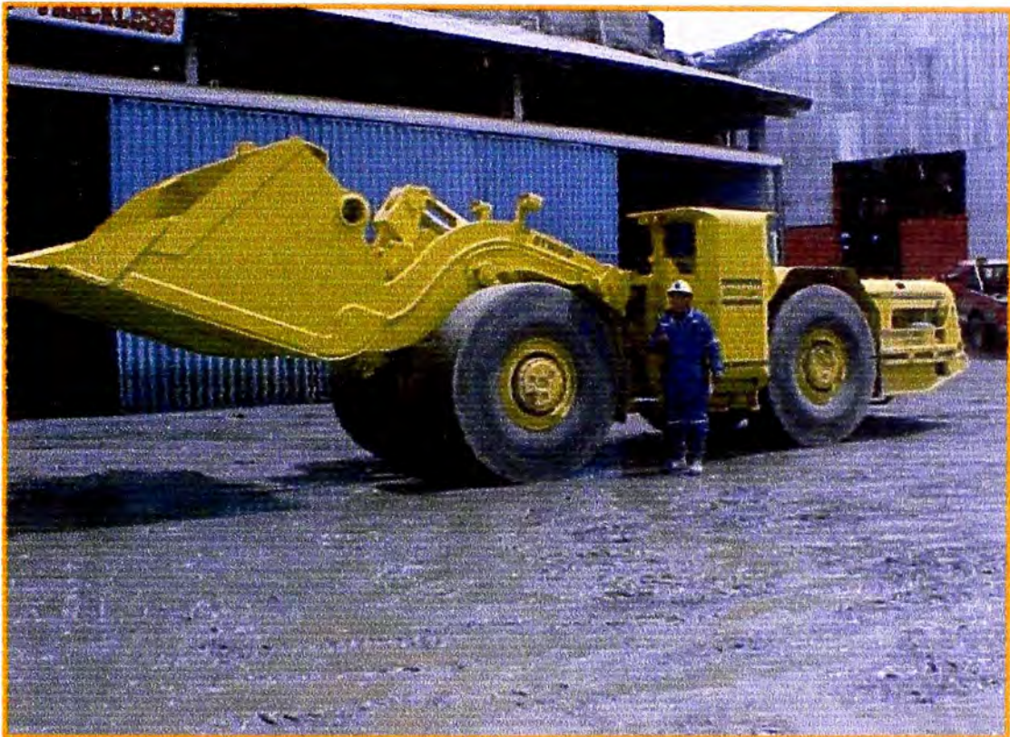
Fotografía N°7: Cargador frontal en vista lateral de capacidad 2.7m 3 .
