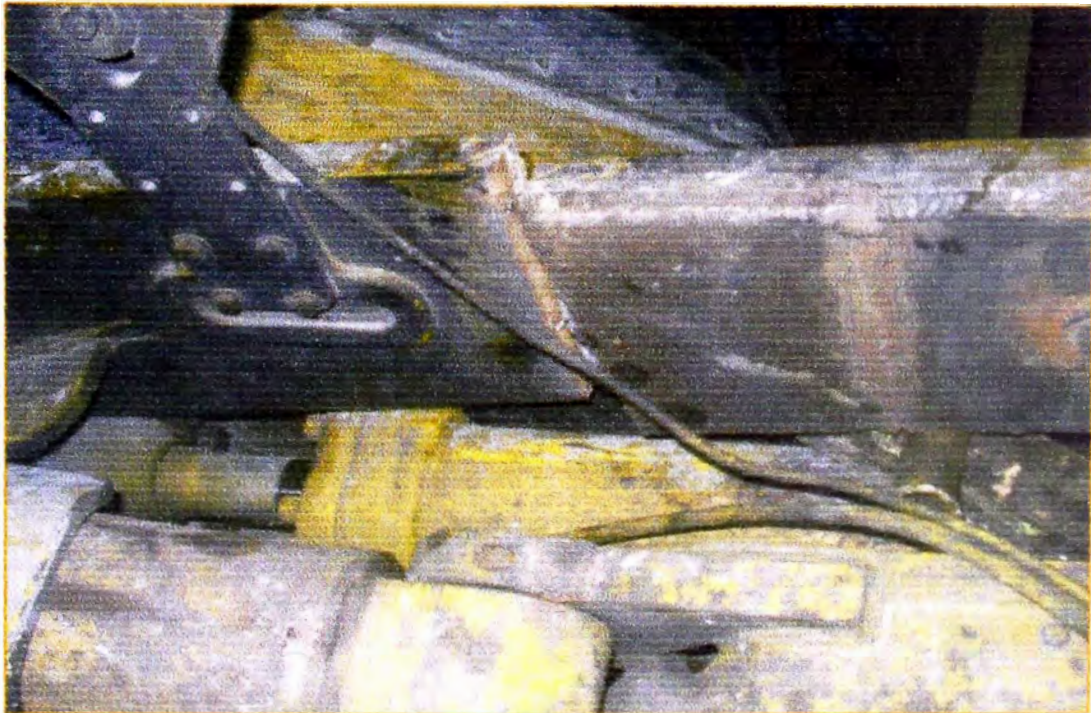
Fotografía N°13: Mostrando fractura frecuente en la estructura del chasis.
