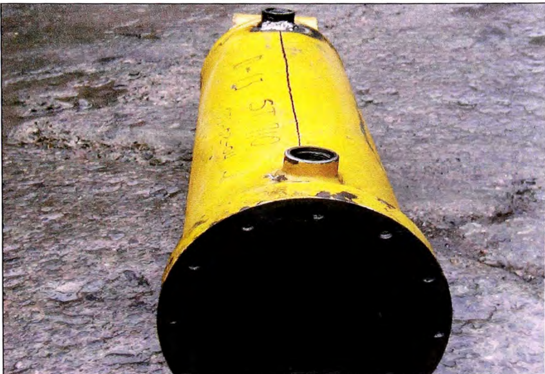
Figura 2.8: Fallas en un componente del Chasis, se observa fractura superficial
