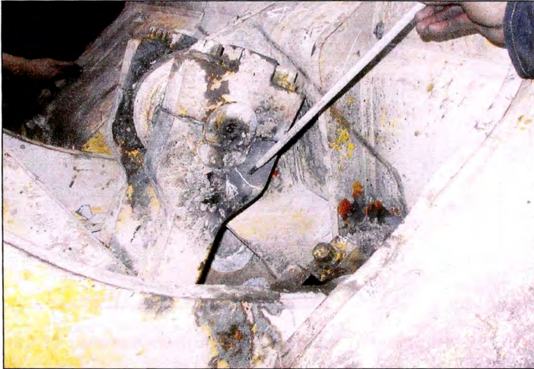
Figura 2.8: Fallas en un componente del Chasis, se observa fractura superficial
