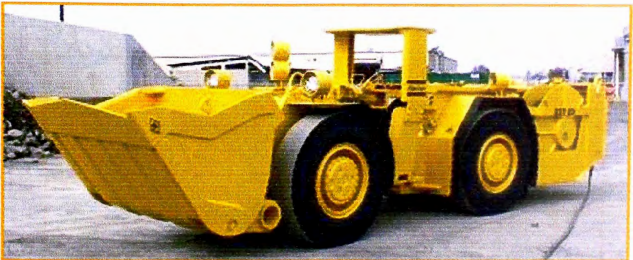
Fotografía N°10: Cargador frontal – Scoop Wagner EST-2D
