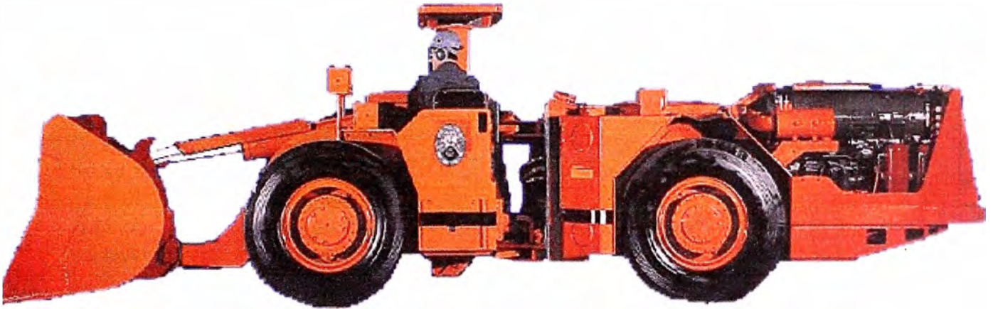
Figura 2.7: Scooptram Diesel en vista de perfil
