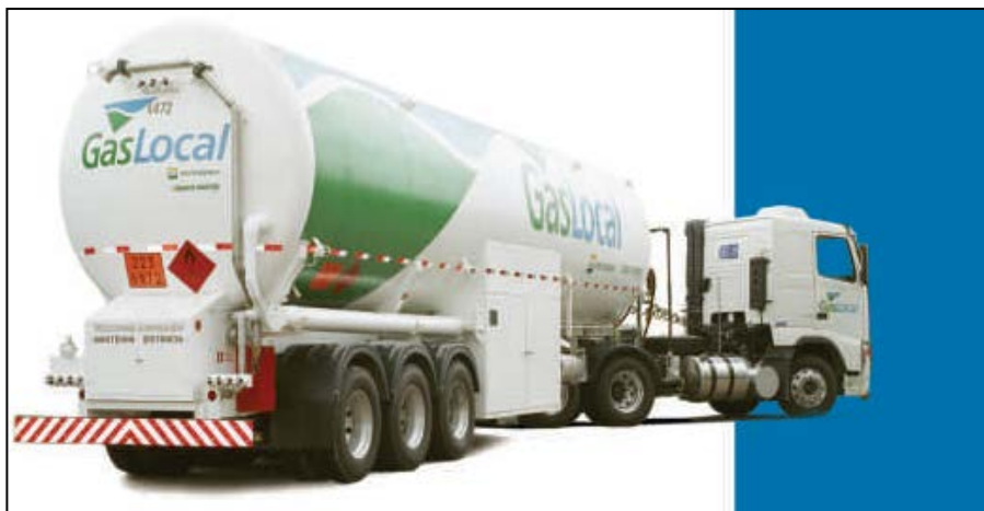
Figura Nº2.1 .-Cisterna criogénica de Gas Local -Brasil
