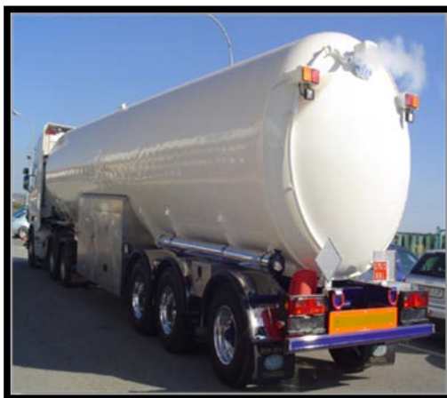
Figura N°2.6.-Cisterna aislada al vacío
