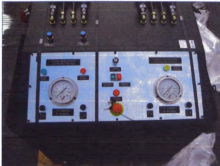
Figura 2.54 Central hidráulica 250/700 bar - Fuente: Ulma C y E, S. Coop
