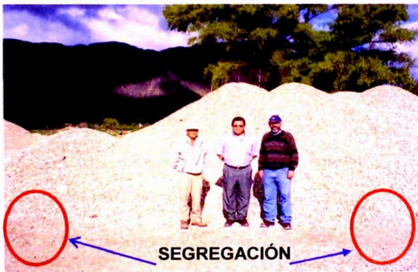
Foto 2.16 Segregación de los agregados en la pila ubicada La Victoria Cajamarca
