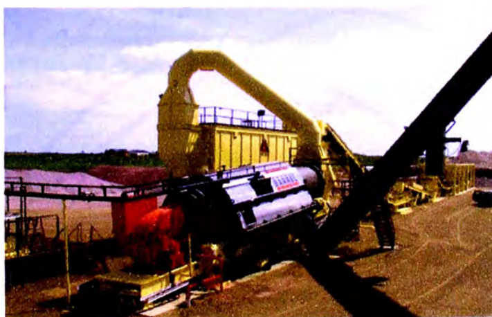
Foto 5.9 Moderna planta de asfalto con tambor Double Barrel de ASTEC la cual produce mezclas asfálticas de alta calidad con bajos costos de producción operación y mantenimiento
