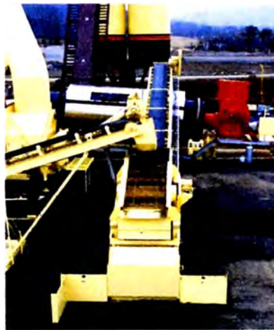
Figura 4.81 Sistema de fajas y tamices para el RAP
