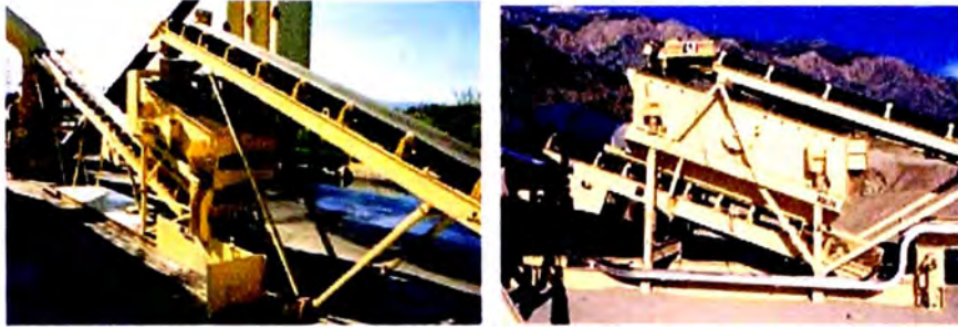
Foto 4.80 Conjunto de faja de agregados vírgenes, zaranda de rechazo, zaranda preliminar y puente báscula montado sobre chasis
