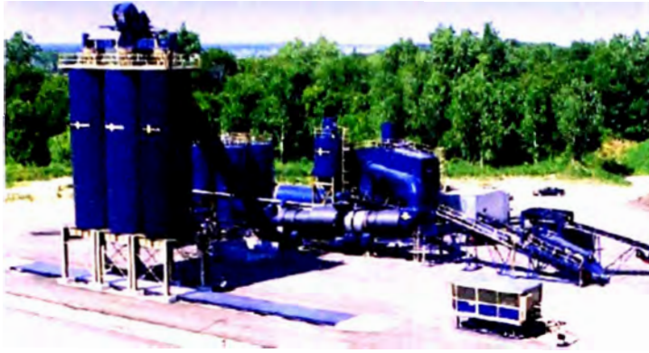
Foto 4.39 Planta de asfalto con tambor mezclador de contraflujo triple Drum de CMI
