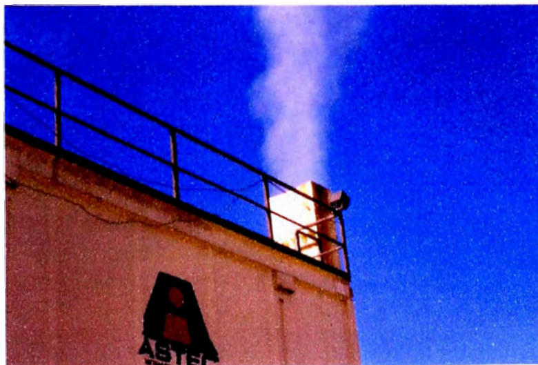
Foto 4.32 Salida de vapor de agua por la chimenea de la planta ASTEC con 0% de opacidad
