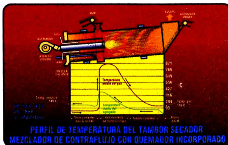
Figura 3.26 Perfil de temperatura tambor secador mezclador de contraflujo con quemador incorporado
