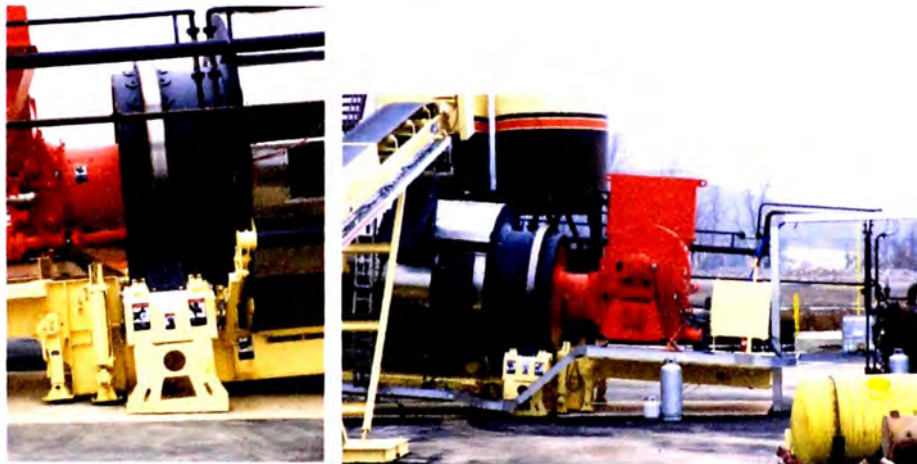
Foto 4.86 Soportes y tornillos de ajuste para nivelación del Double Barrel
