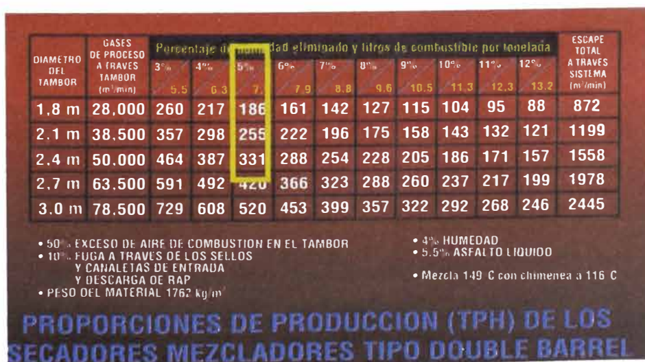
Figura 6.13 Producción horaria de mezcla asfáltica de los tres tamaños de plantas
