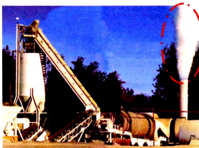
Foto 3.5 Planta de asfalto antigua en operación emitiendo altos niveles de polución
