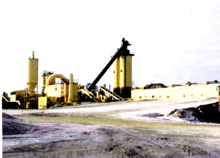
Foto 4.59 Planta de asfalto con tambor Double Barrel operando en Nashville Alabama E.U.A
