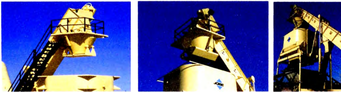
Foto 4.98 Dosificador de mezcla en caliente
