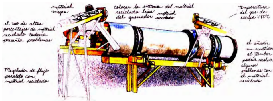
Figura 4.49 Mezclador de flujo paralelo con ingreso de RAP
