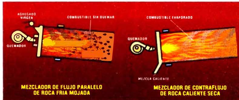
Figura 4.63 Eficacia térmica del tambor mezclador secador
