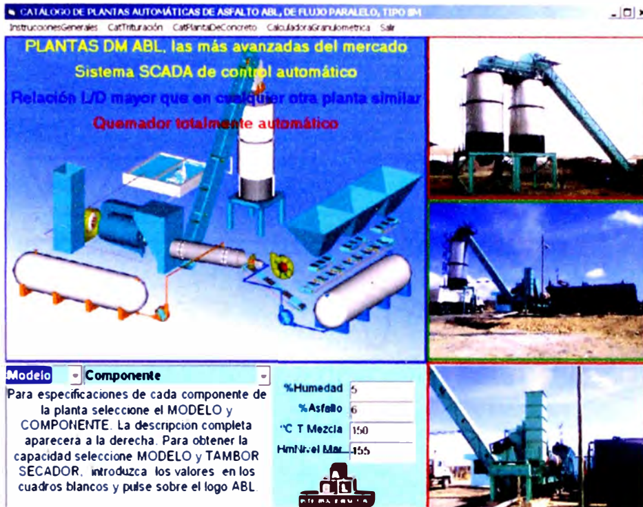
Figura 2.67 Con el sistema SCADA es posible obtener la información de las variables críticas
