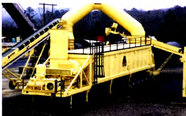
Figura 4.91 Filtro de mangas o baghouse y sistema hidráulico de nivelación hidráulica
