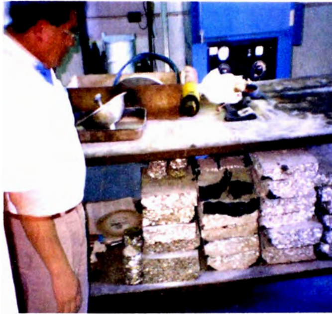
Figura 1.55 Briquetas de mezcla asfáltica preparadas para ensayos en el laboratorio de pavimentos de la Empresa Tito Castro Inc, en Ponce Puerto Rico.
