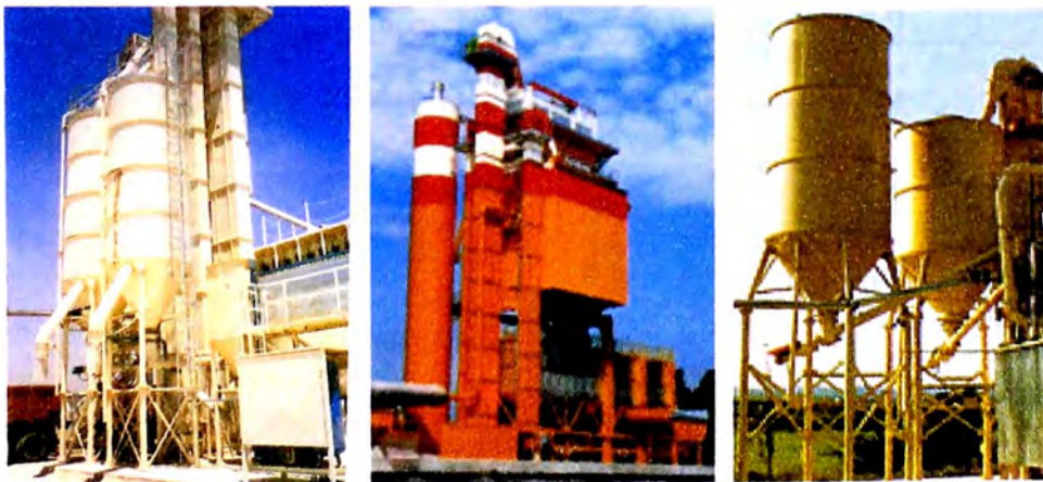
Foto 1.85 Silos para el filler con capacidades desde 8m 3 - 75 m 3 (10tn -100 tn)
