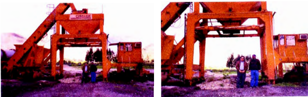
Foto 1.101 Planta de asfalto Ciber de flujo paralelo ubicada en Cajamarca Ing° Hugo Miranda Tejada e Ing° Juan Carlos Ubillus Calmet realizando la evaluación técnica
