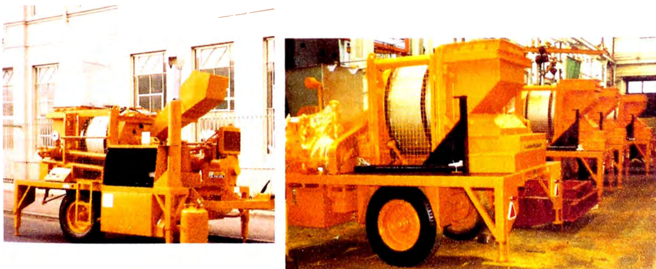
Foto 1.57 MIXBATCH PLANT Pequeña Batch Plant sobre remolque con capacidad de producción de 4-9 tph
