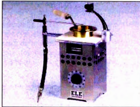
Aparato para la Determinación del Punto de Inflamación Cleveland de Copa Abierta ASTM D 567-97 AASHTO T 411
