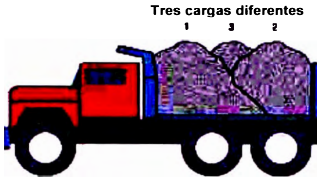
Figura 2.39 Carga incorrecta del camión
