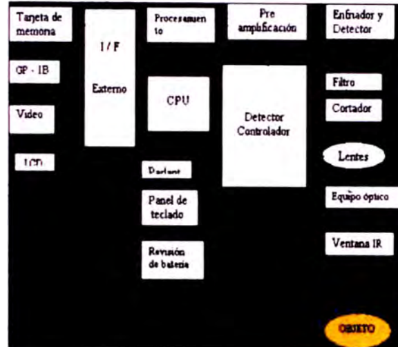
Figura 3.57 Esquema de funcionamiento de una cámara de rayos infrarrojos
