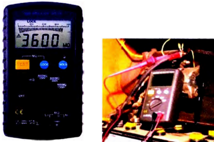
Figura 3.69 Megómetro o medidor de aislamiento
