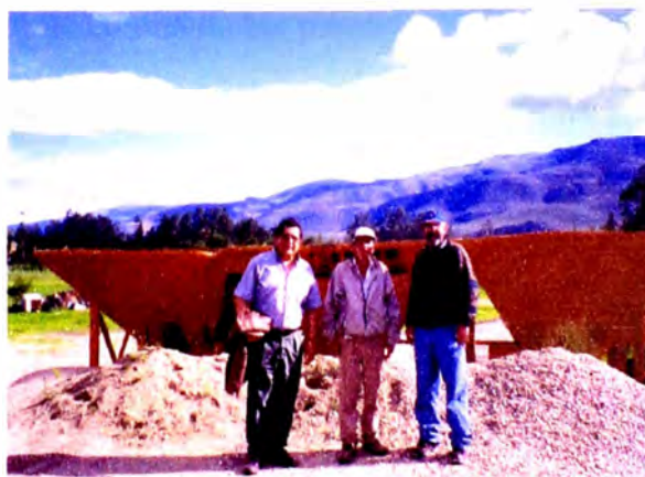
Foto 2.19 Tolva alimentadora de agregados en frío con apertura rectangular de la Planta de Asfalto CIBER ubicada en Cajamarca, Ing o Hugo Miranda Tejada, Sr. Pastor Caro Responsable del MTC e Ing o Juan Carlos Ubillus
