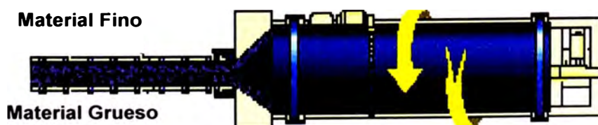
Figura 2.25 Las represas retardan el flujo en el secador mezclador
