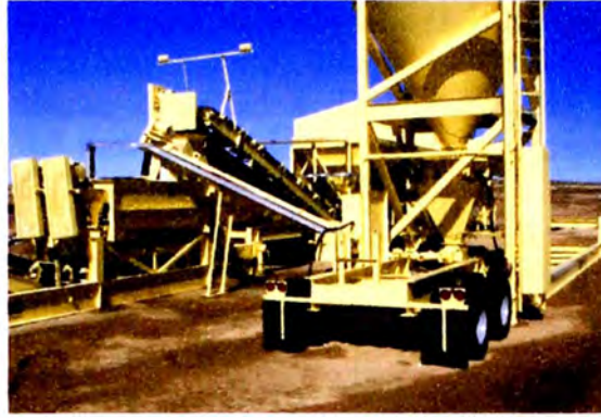
Figura 4.102 Dos cilindros hidráulicos grandes empujan al silo de aditivos a su posición vertical
