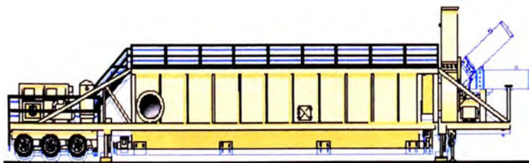
Foto 4.92 Filtro de mangas o baghouse y ciclón
