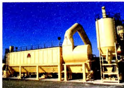
Foto 4.92 Filtro de mangas o baghouse y ciclón
