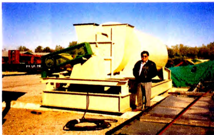
Foto 3.37 Sistema colector de polvos listo para el montaje en una planta en Indiana E.U.A
