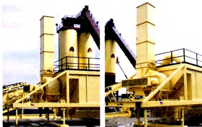
Foto 4.95 Soportes y tornillos de nivelación del chasis del ciclón
