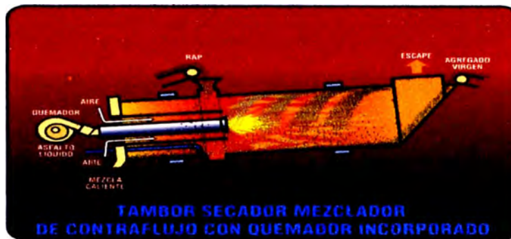
Figura 3.25 Tambor secador mezclador de contraflujo con quemador incorporado
