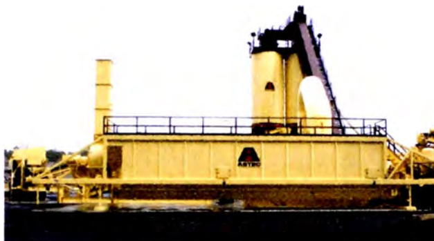
Foto 4.90 Baghouse de la planta de asfalto ASTEC
