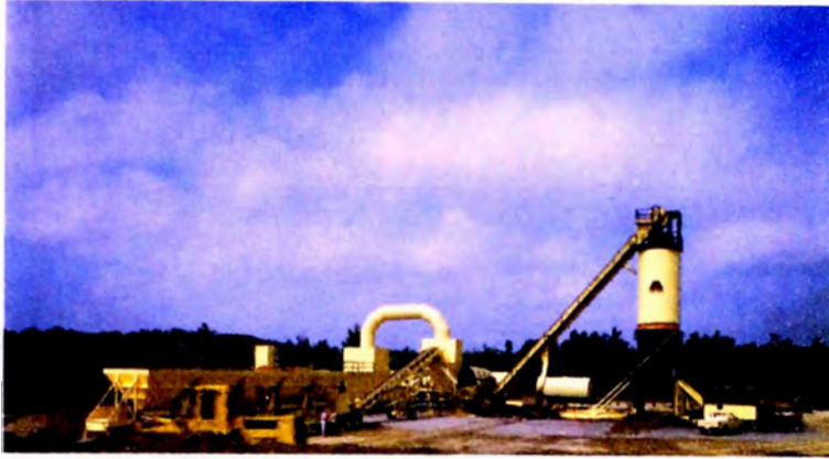
Foto 4.24 Moderna planta de asfalto con tambor mezclador de contraflujo Double Barrel de ASTEC
