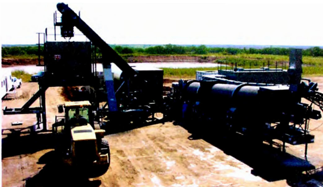
Foto 4.18 Planta de asfalto de tambor mezclador de contraflujo
