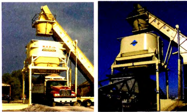
Foto 4.99 Tolva de mezcla asfáltica en caliente
