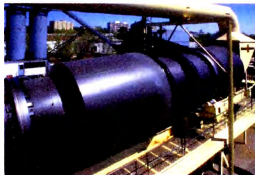
Foto 4.44 El tambor mezclador de contraflujo Triple Drum de CMI tiene distintos diámetros para cada zona
