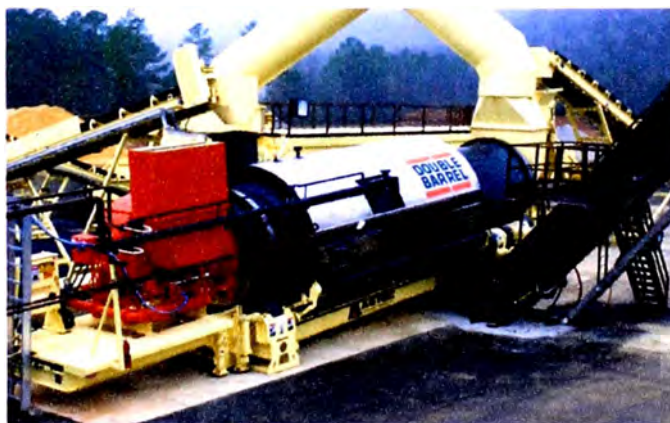
Foto 4.57 La planta de asfalto ASTEC tiene la mejor tecnología para la producción de mezclas asfálticas en caliente
