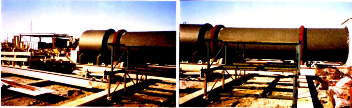
Foto 3.35 Vigas de acero que forman el chasis principal para soportar al tambor mezclador
