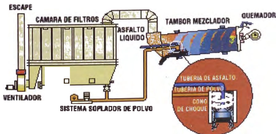
Figura 7.31 Sistema de retorno de polvo del tambor mezclador
