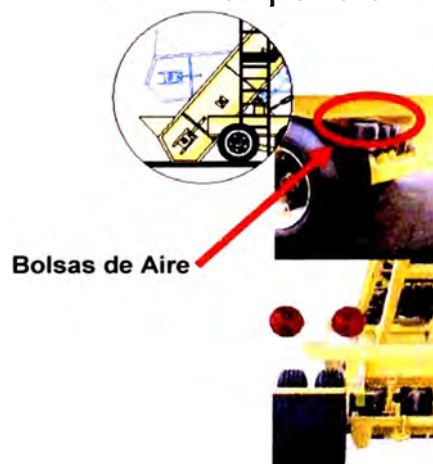
Figura 4.68 Facilidad las suspensiones con bolsas de aire elevan las cargas y brindan una suspensión uniforme cuando se transporta la planta.
