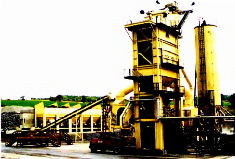
Foto 4.3 Batch plant de ASTEC producción 400 tph de mezcla asfáltica
