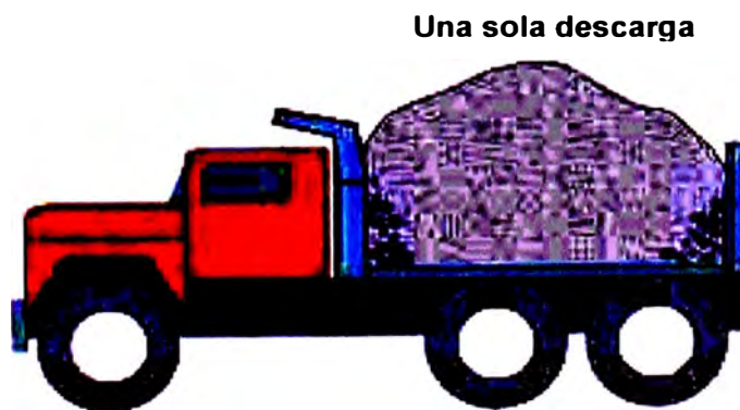
Figura 2.38 Carga incorrecta del camión
