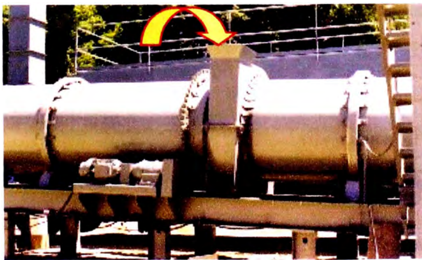
Foto 4.13 Zona de ingreso de RAP en el tambor mezclador de flujo paralelo
