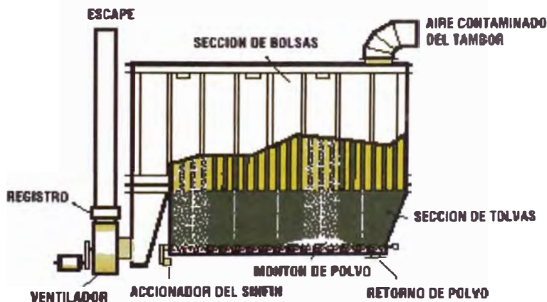
Figura 7.30 Acopio de polvo en la cámara de filtros o baghouse
