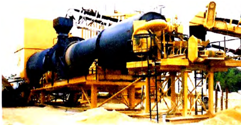
Figura 1.104 Tambor mezclador de flujo paralelo Venturi-Mixer de CMI Corporation del año 1,982 con ingreso de RAP
