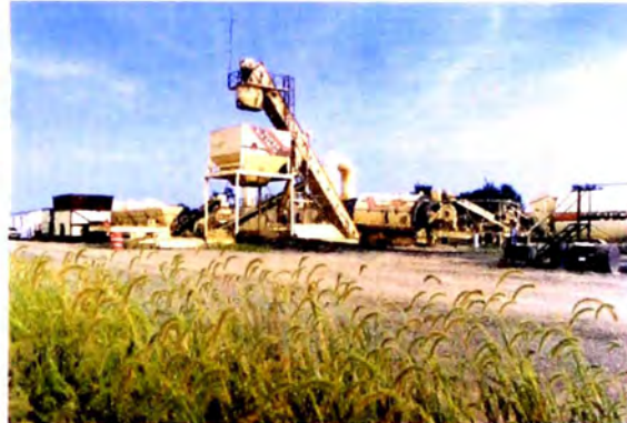
Foto 4.66 Planta de asfalto portátil Turbo Six Pack de ASTEC
