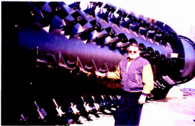
Foto 4.25 Paletas Mezcladoras Externas del Tambor Mezclador de ContraFlujo Double Barrel de ASTEC mostradas por el Ing. Carlos Suárez Director of Sales de ASTEC
