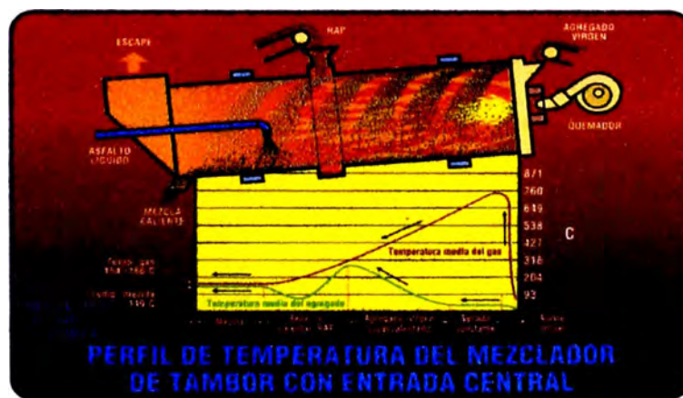
Figura 3.23 Perfil de temperatura del mezclador de tambor con entrada central
