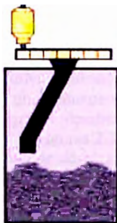
Figura 2.31 Tubo de descarga giratorio
