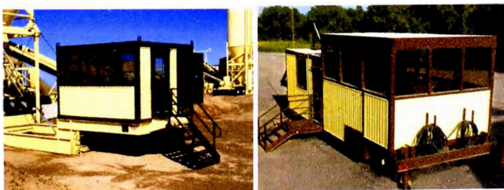
Foto 4.112 Facilidad del ensamblaje de escalerillas, peldaños y barandas
