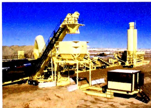
Foto 4.74 Tabiques ubicados debajo de la faja transportadora de mezcla asfáltica en caliente
