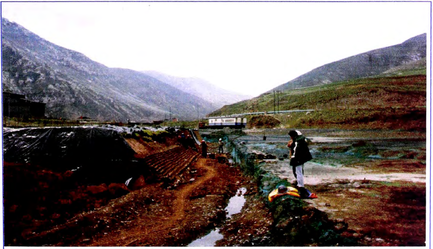
Fotografía N° 6: Evaluación de filtraciones en cancha de relaves mineros.
