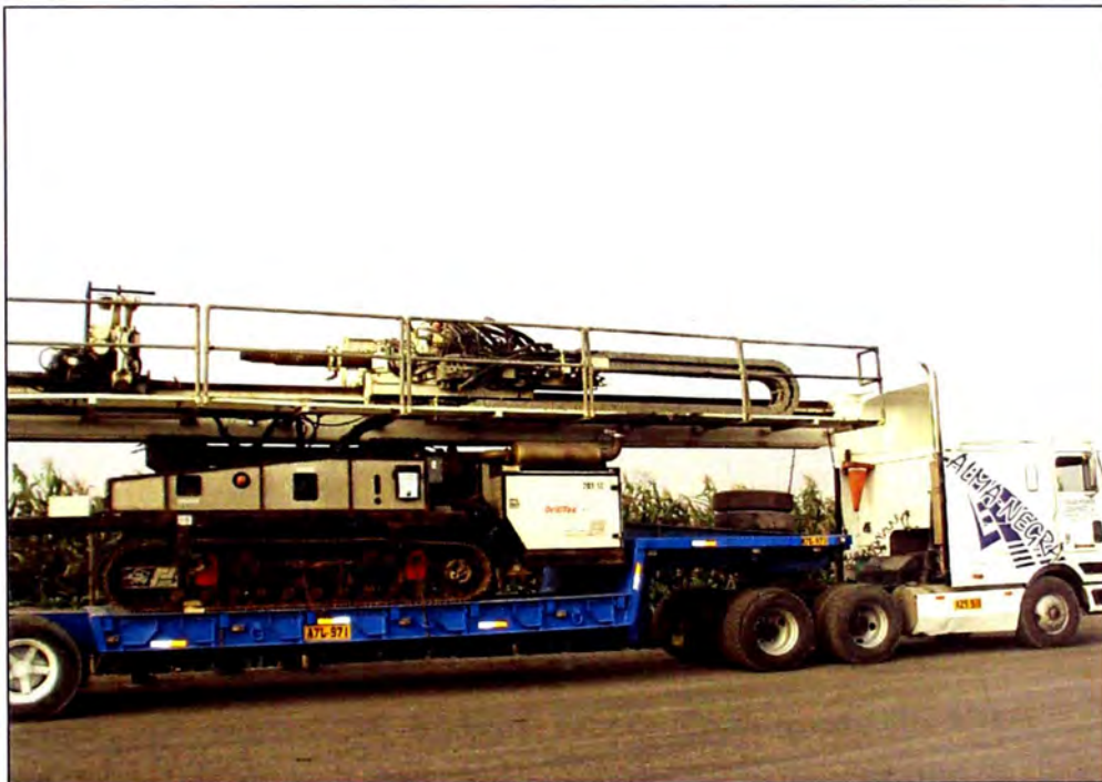
Figura N°1.1.- Movilización del equipo de perforación a obra.
