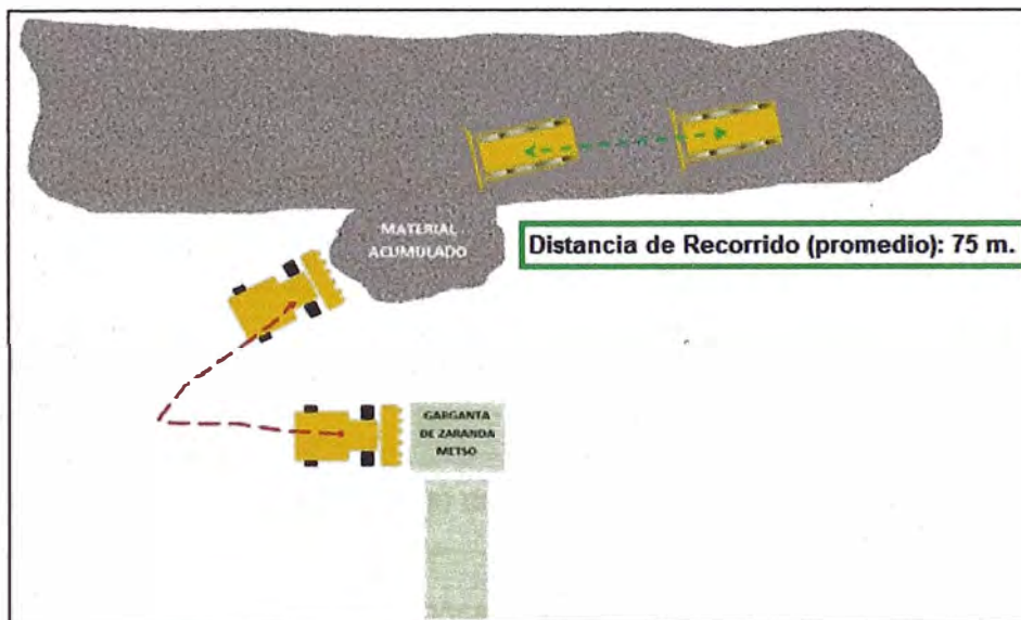
Figura N° 60.- Situación Implementada del Tractor en explotación en cantera
