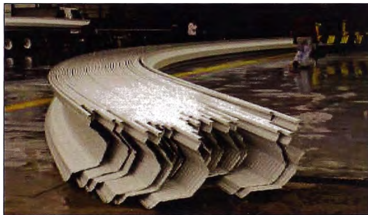
Figura 31. Vista de la acumulación de arcos que salen de la maquina conformadora.
