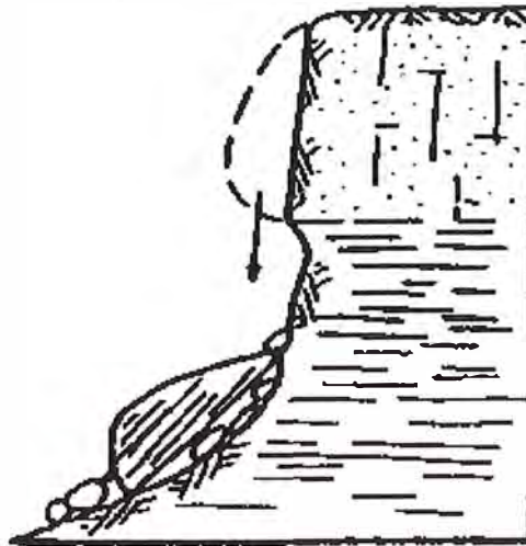
FIGURA N° 1.2. Desprendimiento de bloques
