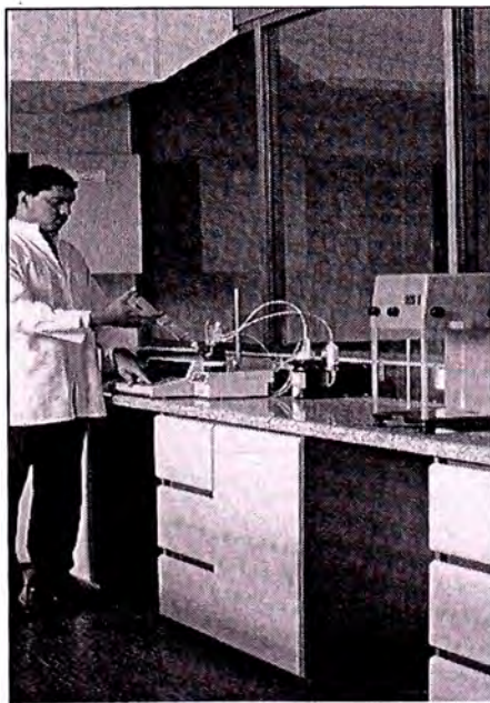
Figura N° 31: Medición del Contenido de Humedad (Karl Fisher)
