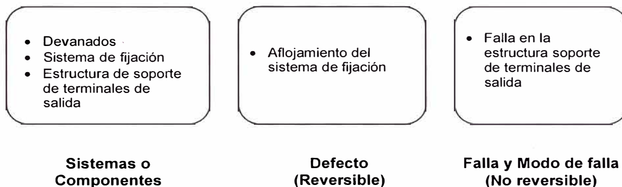
Figura N° 45: Modos de Falla en Componentes Mecánicos
