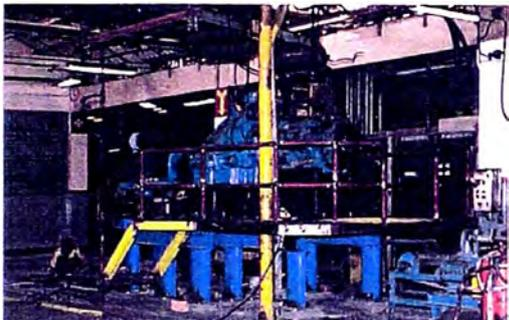
**FOTO 5.9 ELEVACION DE EXTRUSORA SIMPLE
