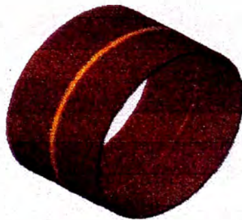
Figura 7.7: Longitud de la soldadura
