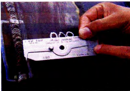
Figura 5.13 : Medición de discontinuidades
