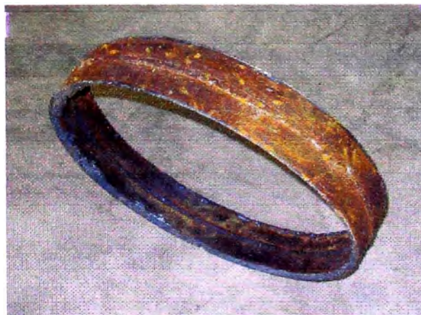
Figura 7.17: Corte de una junta rechazada
