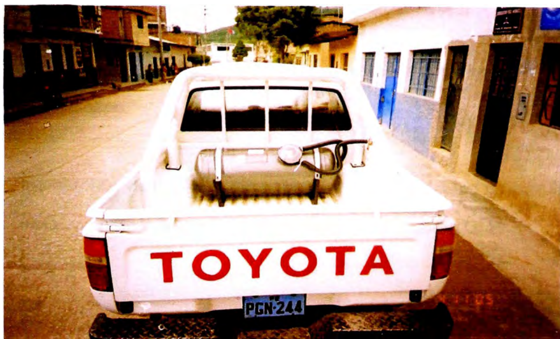
Figura N° 14: Ubicación del tanque de GLP
