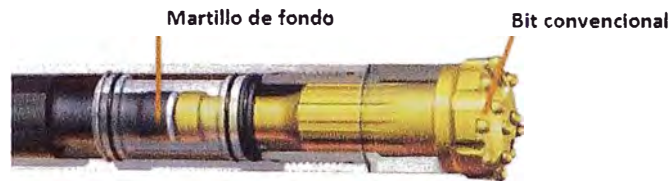
Figura 64 - Punta de perforación sistema convencional
