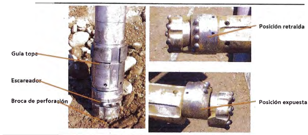
Figura 65 - Punta de perforación sistema de escareador excéntrico.
