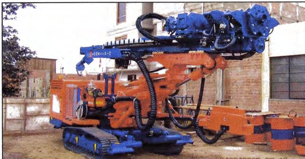
Figura 47 a - Perforadora hidráulica Comacchio
