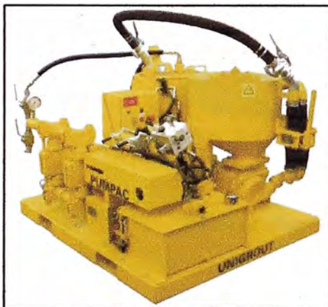
Figura 50 - Inyectora Atlas Copco – Unigrout,
