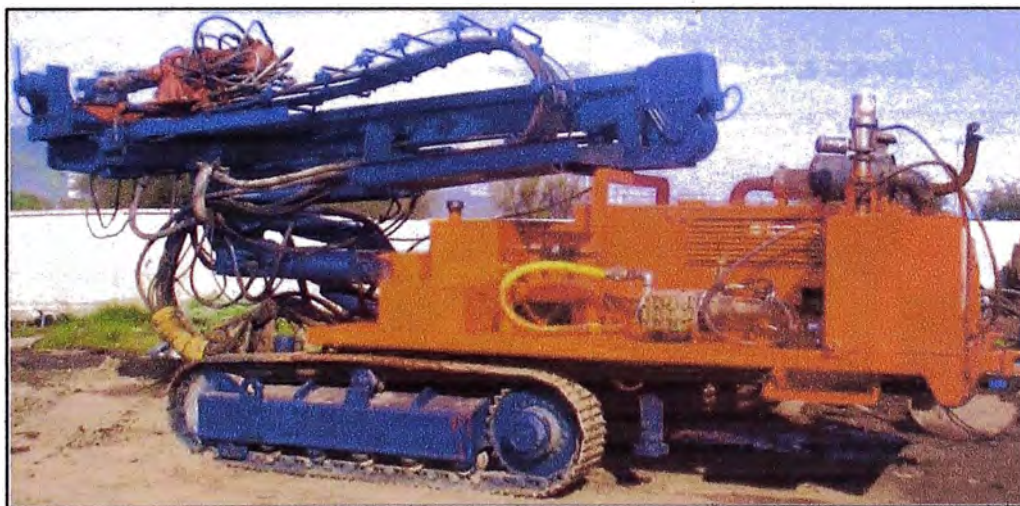
Figura 46 a - Perforadora hidráulica marca ATLAS COPCO
