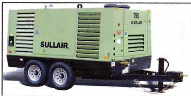
Figura 48 - Compresor de aire, Marca Sullair
