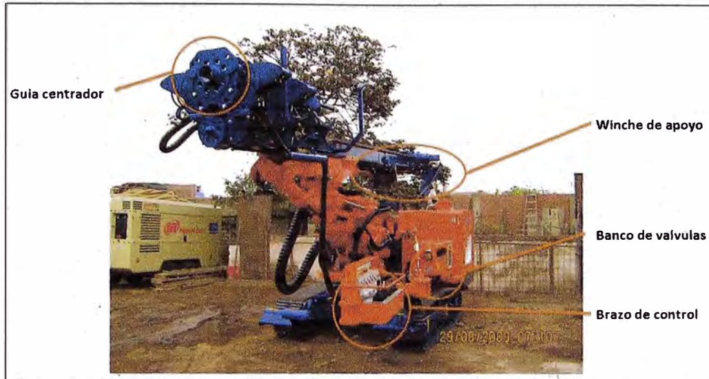
Figura 45 - Perforadora hidráulica Marca Comacchio modelo MC800
