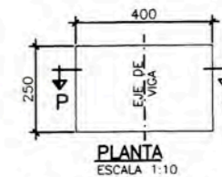
DETALLE DE NEOPRENO DE APOYO (UNIDADES mm)
