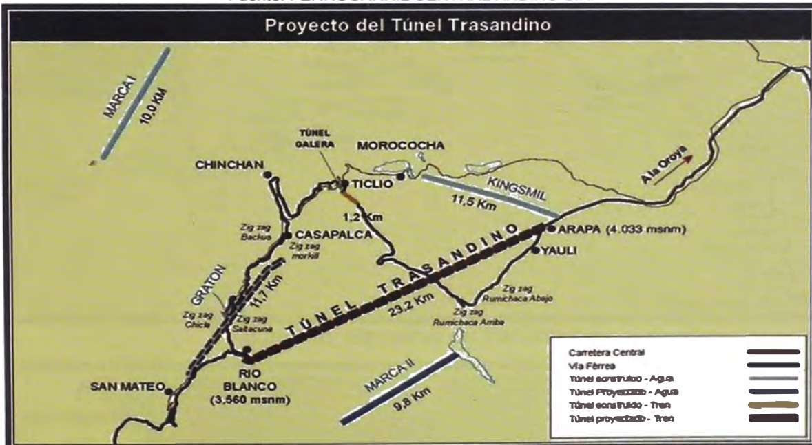
Figura N°11: Proyecto del Túnel Trasandino.
