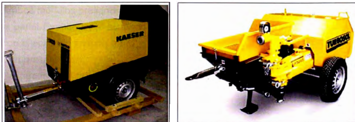
Figura N° 2.12.- Compresora de aire (izquierda) y bomba de proyección de mortero (derecha)
