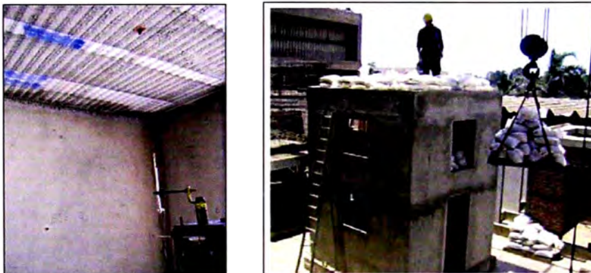
Figura N° 2.14.- Prueba de Carga Vertical del Módulo
