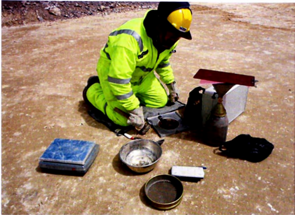
Foto N°09.- Control de compactación en campo con cono de arena-MT1
