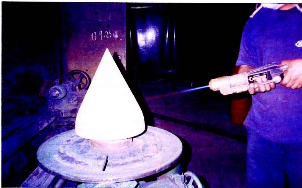
Figura 39. Aplicación de recubrimiento a aguja de turbina Pelton.
