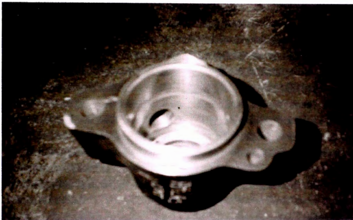
Figura 38. Cabezal delantero terminado (después de su rectificado), se ha obtenido como medida final los diámetros estándares.
