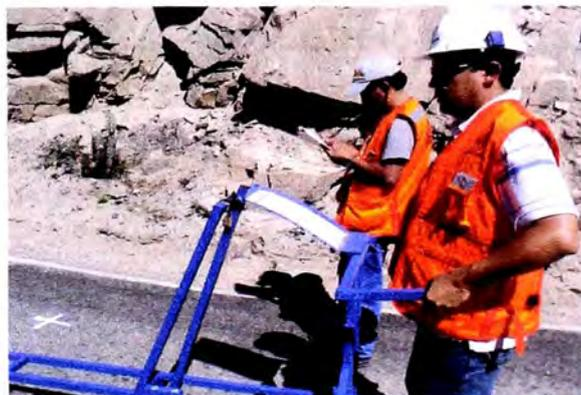
**Fotografía N° 4.02 Toma de datos con equipo MERLIN – Tramo 2**
