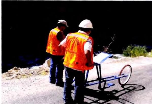
**Fotografía N° 4.03 Toma de datos con equipo MERLIN – Tramo 3**
