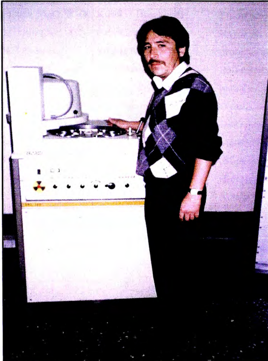
Fig. 5. Cámara del Equipo de Fluorescencia RX: Lugar donde se coloca las probetas.
