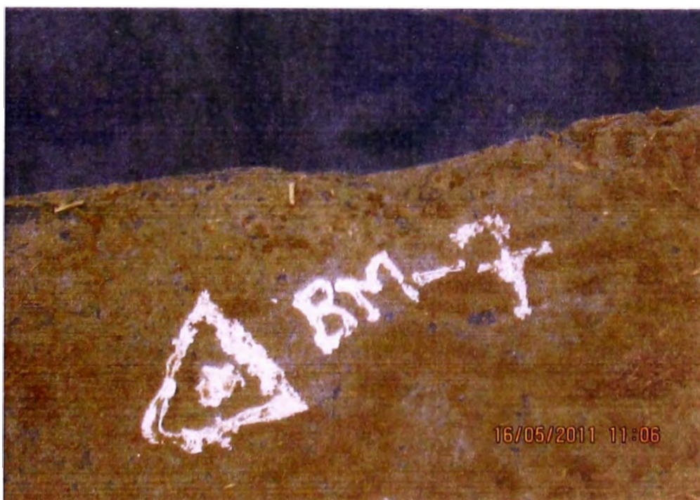
FOTON°18 UBICACIÓN DE BM7 (COTA= 236.419), ENCIMA DE LOSA DE PUENTE DE CONCRETO UBICADO AL INICIO DEL CENTRO POBLADO CANTERA Y A UN COSTADO DE BM6 .
