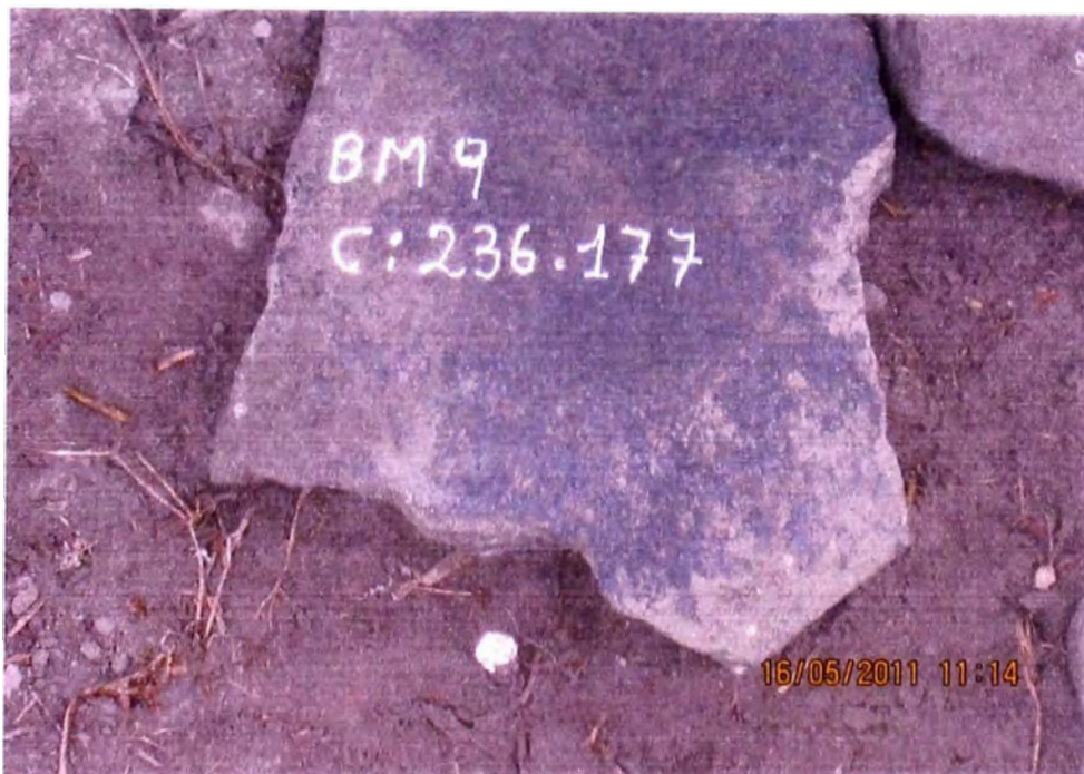
FOTON°22 UBICACIÓN DE BM9 (COTA= 236.177), SE COLOCO FIERRO AL INICIO DEL CAMINO DE PENETRACION A LAS FUTURAS LAGUNAS DE OXIDACION, A UN COSTADO DEL PUENTE EXISTENTE
