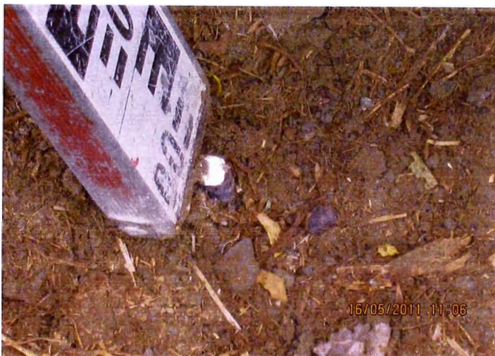
FOTON°17 UBICACIÓN DE BM6 (COTA=236.152), EN ESQUINA DE PUENTE DE CONCRETO QUE PERMITE EL INGRESO AL CENTRO POBLADO CANTERA, SE OLOCO FIERRO
