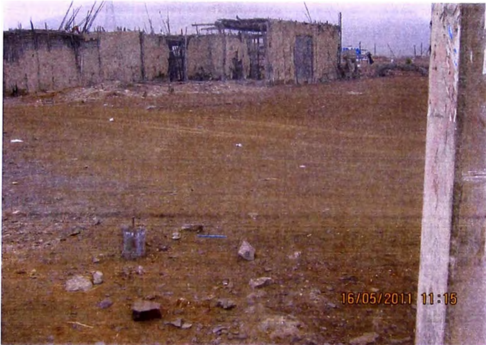
FOTON°19 UBICACIÓN DE BM8 (COTA= 238.227), ENHITO DE CONCRETO AL FRENTE DEL CAMINO DE INGRESO PARA LAS FUTURAS POZAS DE OXIDACION.
