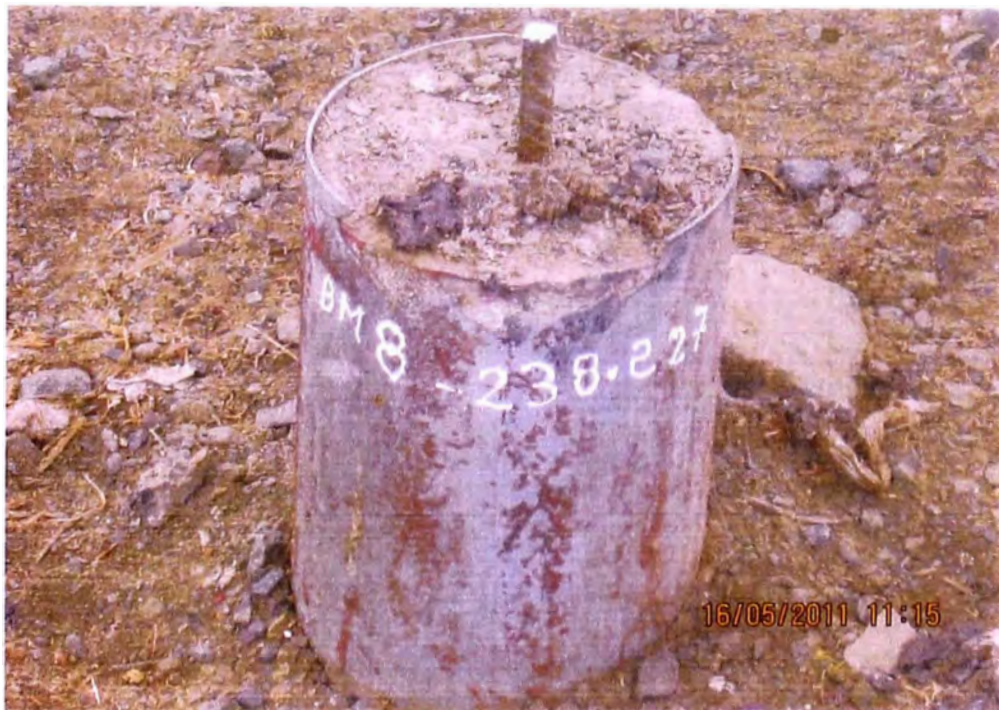
FOTON°20 UBICACIÓN DE BM8 (COTA= 238.227), ENHITO DE CONCRETO AL FRENTE DEL CAMINO DE INGRESO PARA LAS FUTURAS POZAS DE OXIDACION.
