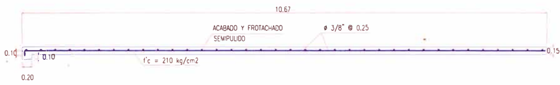
SECCION TIPICA TRAMO 3 P10
