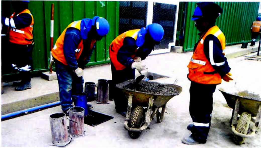
FIGURA N° 15 – LLENADO DE MOLDES PARA LA ROTURA DE PROBETAS DEL TRAMO 02
