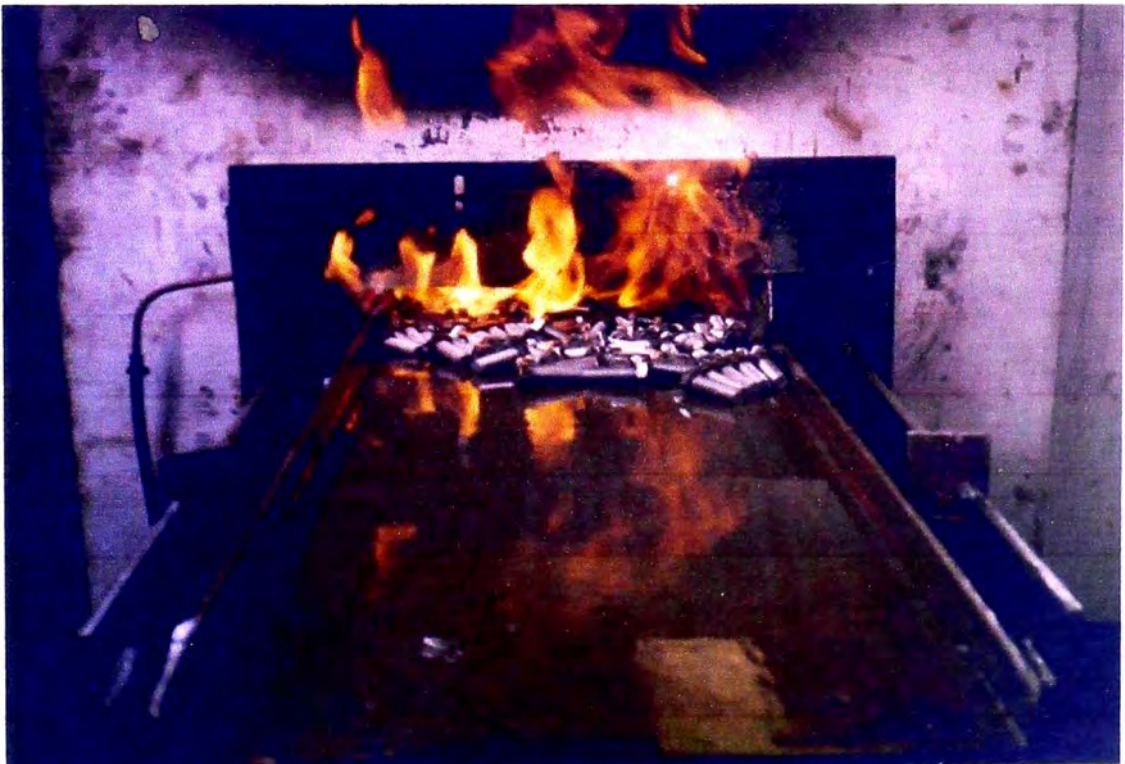
Foto 4.12 Combustión de gas propano en plena operación del horno.
