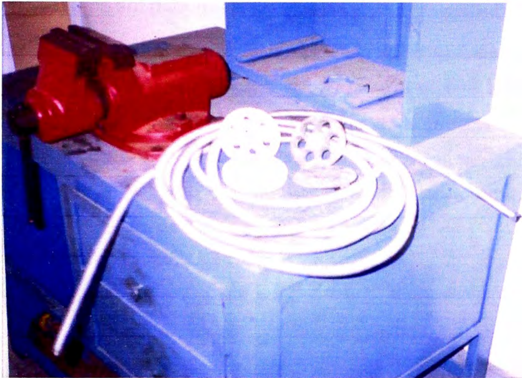
Foto 4.3 Resistencias espiraladas y soportes cerámicos fabricados
