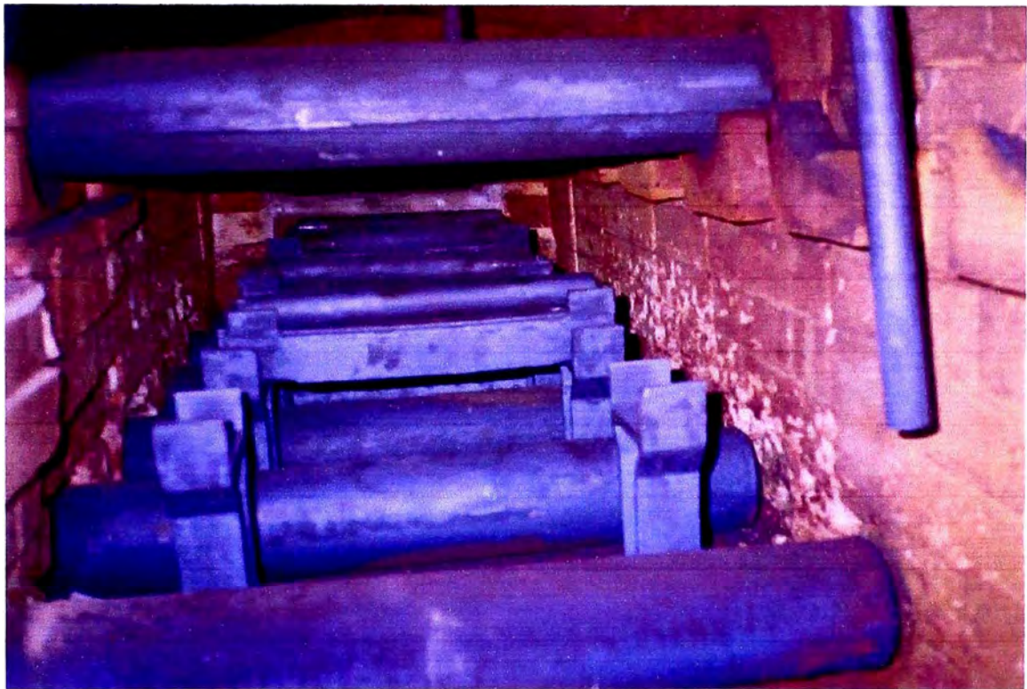
Foto 3.4 Soportes y rodillos en los que se apoya la solera
