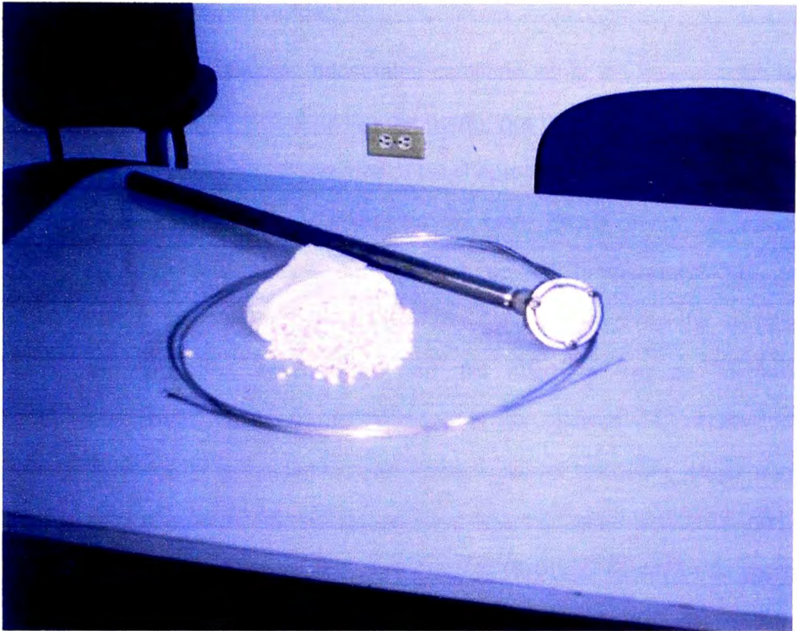
Foto 4.10 Aislador cerámico del alambre para la termocupla
