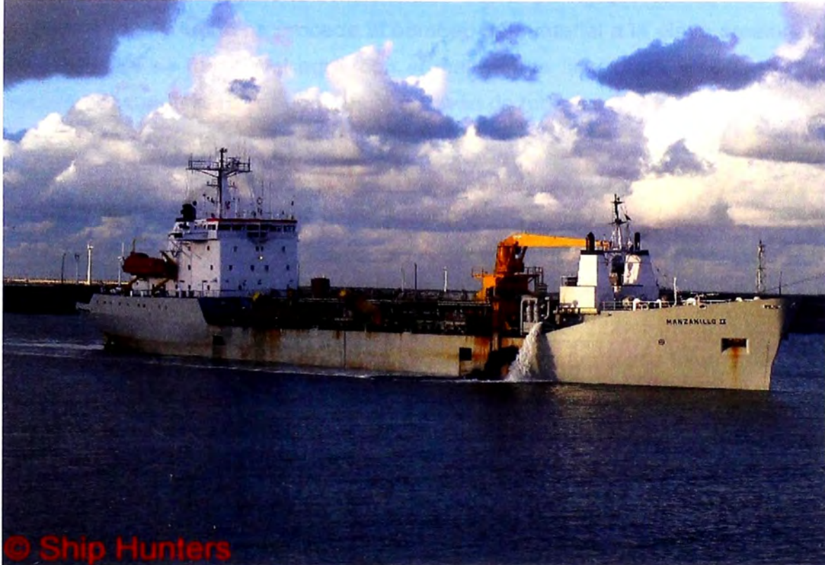
Figura 3.05 Manzanillo II, draga de arrastre y succión en marcha con 4,000m 3 de cántara
