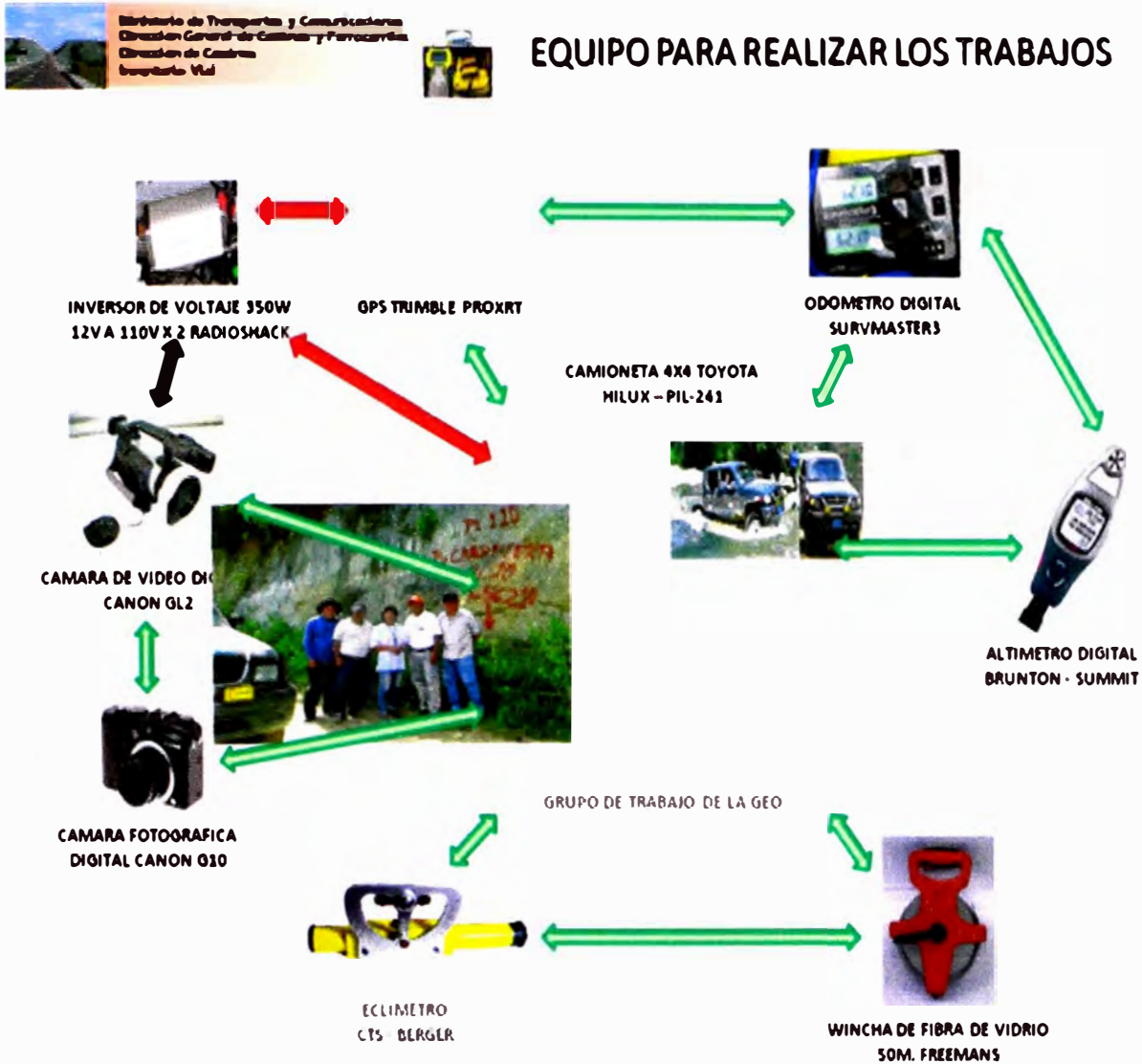
Figura N° 5. 1: Equipo para realizar los trabajos, Fuente: manual de Dispositivos de Control de Tránsito Automotor para calles y carreteras.
