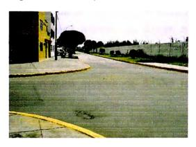
Foto 1.4 Cambio de nivel de 0.15m entre la vereda y la calzada (esquina Av. Ariosto Matellini y Av. El sol-Distrito de Chorrillos)
