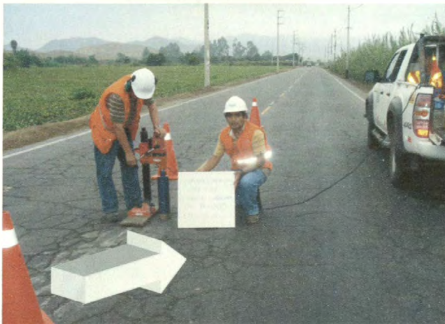
Foto N° 1: Km 28+ 823, calicata para registrar las características del suelo en zona de puntos críticos
